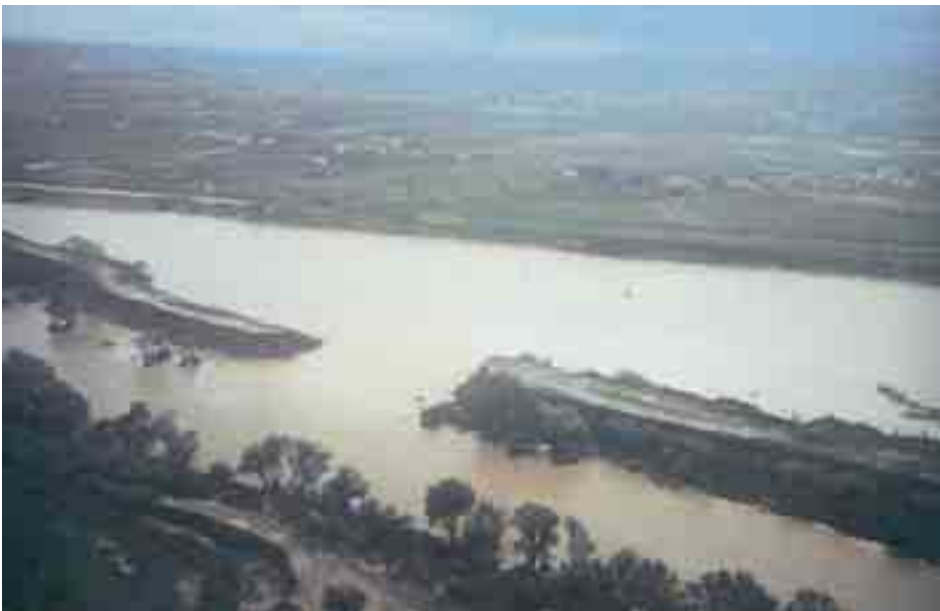
Figura 2.1.12: Rottura dell'argine dell'Arno in località "Roffia", ad ovest di Empoli. La rottura dell'argine, durante l'evento alluvionale del 20-21 ottobre 1992, laminò l'onda di piena abbassando il livello dell'acqua del fiume, a valle, di oltre un metro e mezzo.
