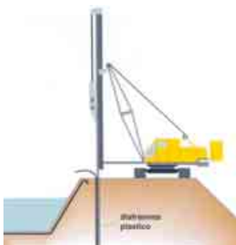
Figura 2.1.4: Quando necessario, soprattutto nel caso di argini esistenti, si può assicurare l'impermeabilità del rilevato arginale mediante geosintetici usati sia in superficie che all'interno dell'argine stesso come un diaframma verticale.
