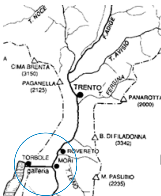
Figura 3.0.3: Scolmatore del fiume Adige, posto all'altezza di Mori. Collega, in galleria, il fiume con il lago di Garda e permette di derivare una parte delle portate nel bacino in caso di piene che superino valori ritenuti critici. In questo caso le acque vengono immesse in un cosiddetto "recipiente" e non vengono restituite al corso d'acqua d'origine.
