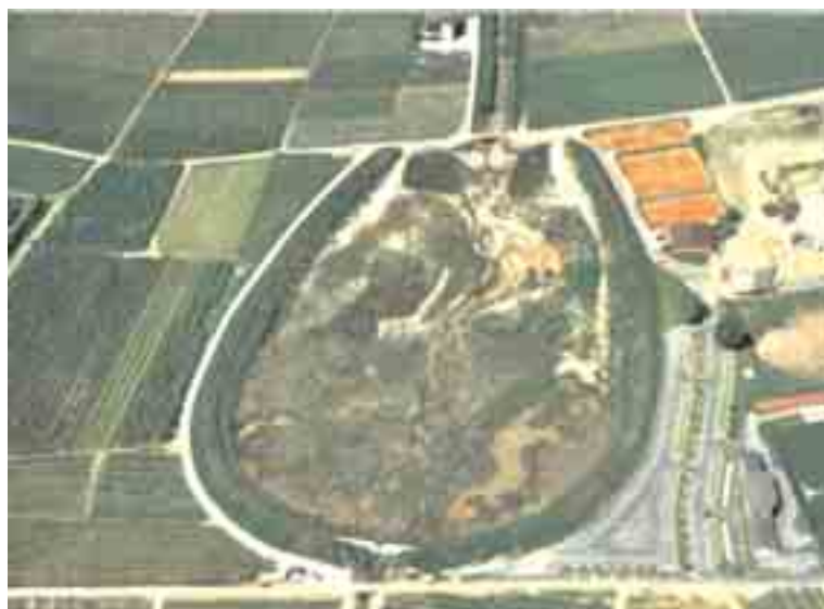
Figura 3.2.8: Veduta aerea di una piccola cassa di espansione in linea che svolge anche la funzione di piazza di deposito. Favorendo il ristagno dell'acqua in alcune porzioni del bacino, l'opera è divenuta anche l'occasione per creare una piccola zona umida. (Rio Inferno, Termeno, BZ)
