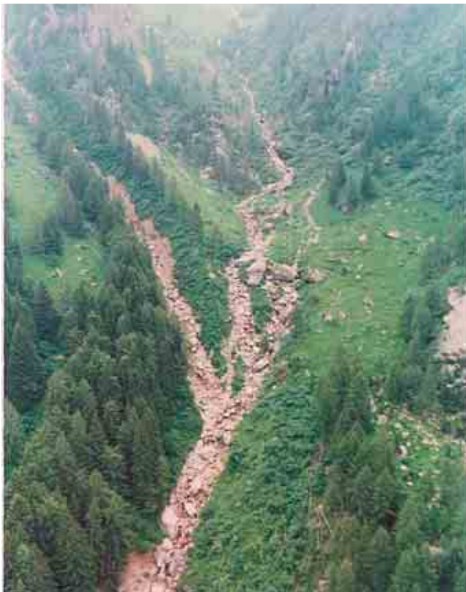
Figura 7.0.5: Il materiale accumulato lungo le aste secondarie molto ripide, può dare luogo all'innesco di colate in occasione di piogge molto intense che siano in grado di saturare rapidamente il materiale accumulato.
