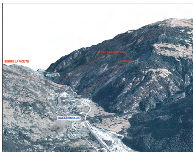
Fig. 4 – La frana del Cassas. Vista della media Valle di Susa verso valle: la presenza di più fenomeni gravitativi contrapposti ha determinato nel tempo il ripetuto sbarramento della Dora Riparia.
