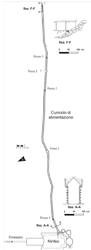
Planimetria del Ninfeo di Egeria e del sistema di alimentazione (rilievo Centro Ricerche Sotterranee "Egeria", 1998).
