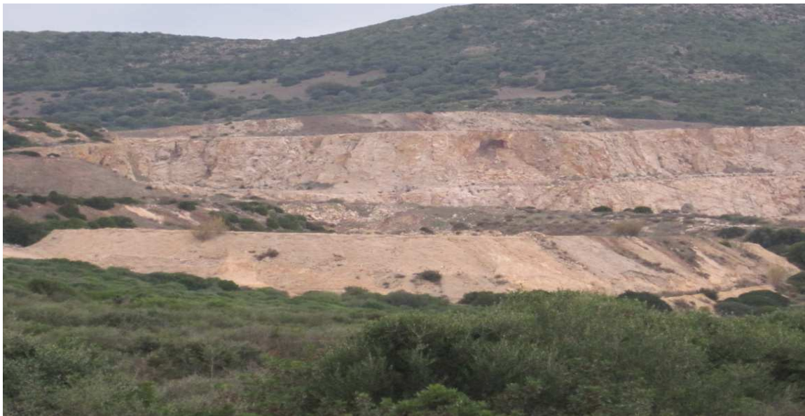
Figura 3.8 Struttura di deposito costituita da cumuli ordinati, cava di calcare a Sant'Antioco (Sardegna)
