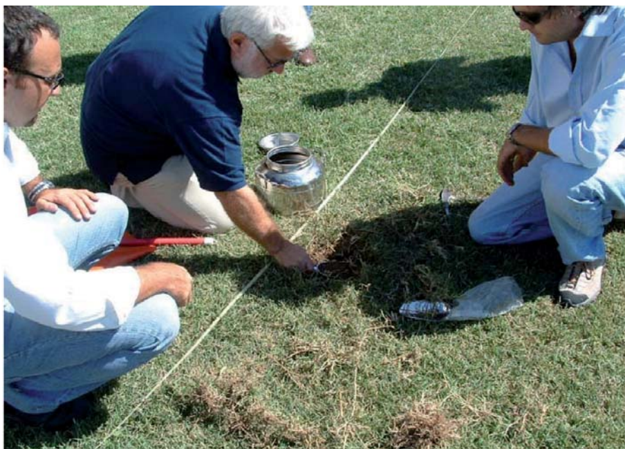
Figura A.7: prelievo dell'incremento e contenitore per l'omogeneizzazione.
