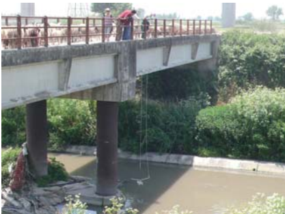
Figura 2.38: Prelievo del campione di sedimenti con draga
