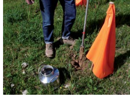
Figura 2.47: Prelievo campione duplicato con carotiere in acciaio
