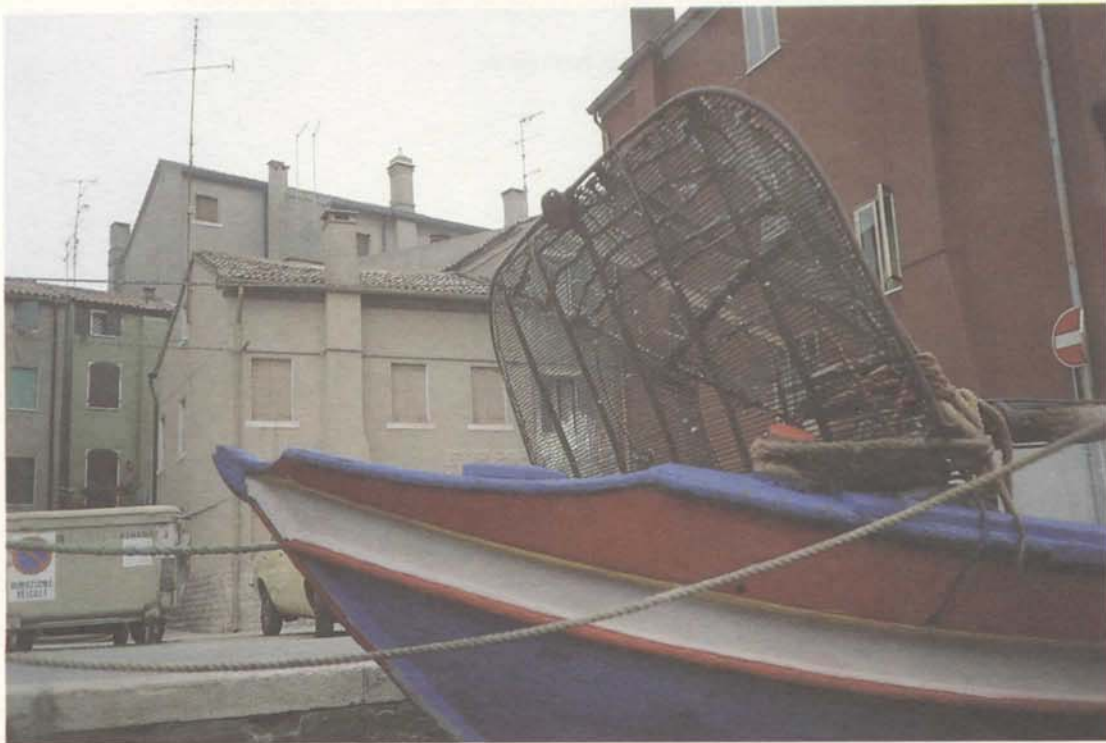
Foto 2: Rastrello manuale usato un tempo per la pesca dalle vongole, ultimo in uso a Chioggia
