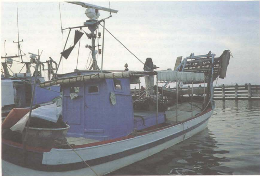
Foto 1: Imbarcazione attrezzata con draga idraulica.
