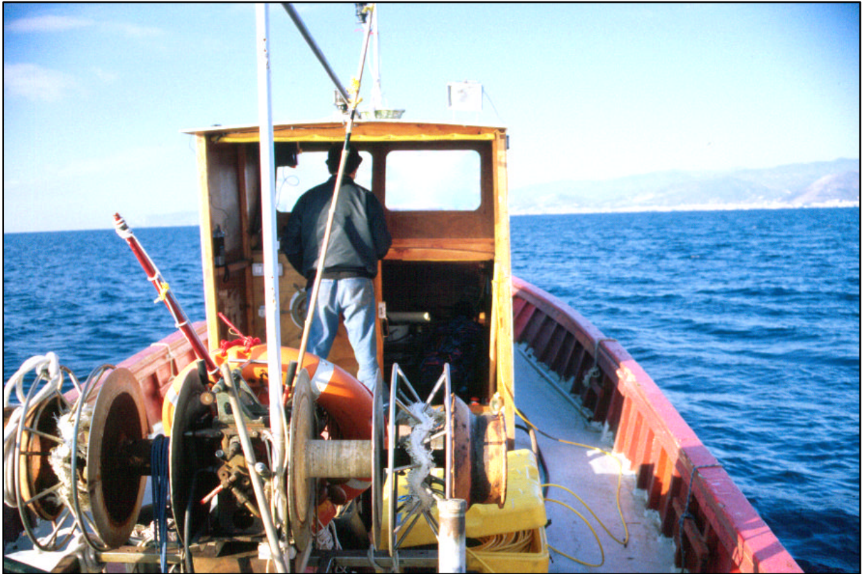
Figura 3.5 - Imbarcazione utilizzata per il rilevamento, in cui si nota in primo piano il verricello idraulico, la plancia di comando e la cabina di lavoro sullo sfondo.
