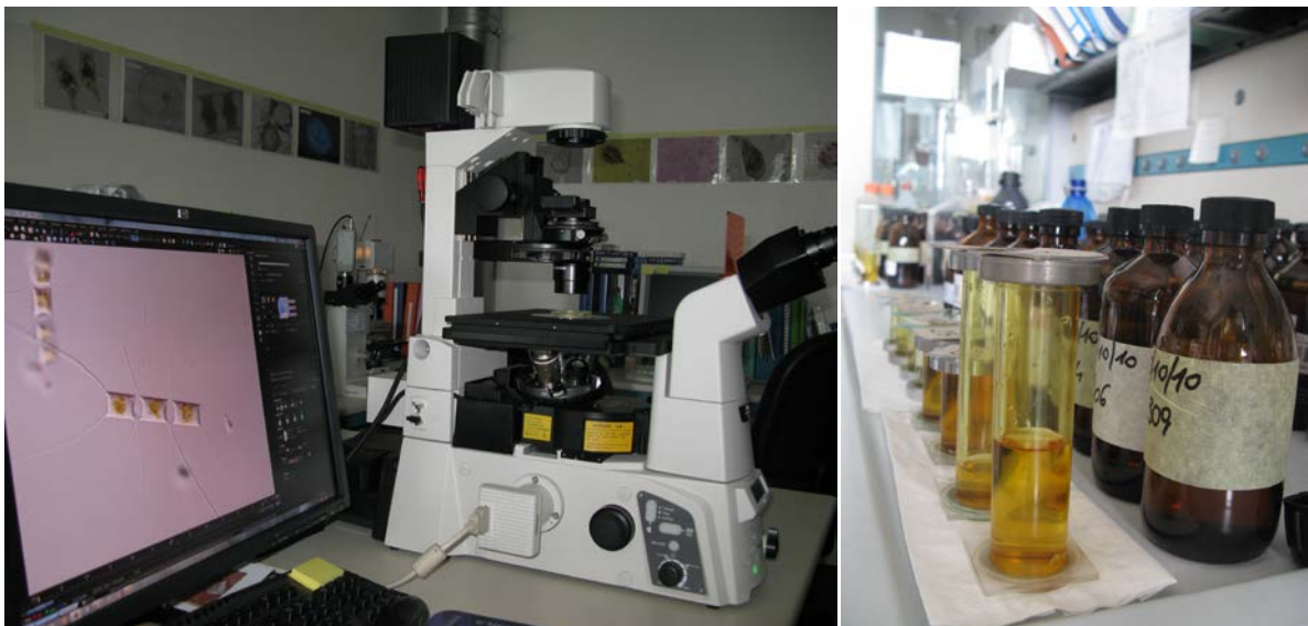
Figura 4.7 - Microscopio Nikon Eclipse Ti utilizzato per l'identificazione ed il conteggio e campioni in fase di sedimentazione.
