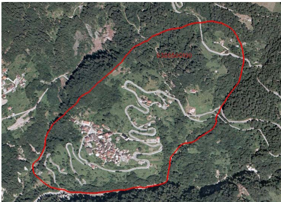
Figura 11.22 Dissesto 0300500100, Comune di Ligosullo (Udine). Il movimento franoso coinvolge l'intero capoluogo comunale. Si tratta di un fenomeno di scivolamento attualmente in fase di monitoraggio e di studio.
