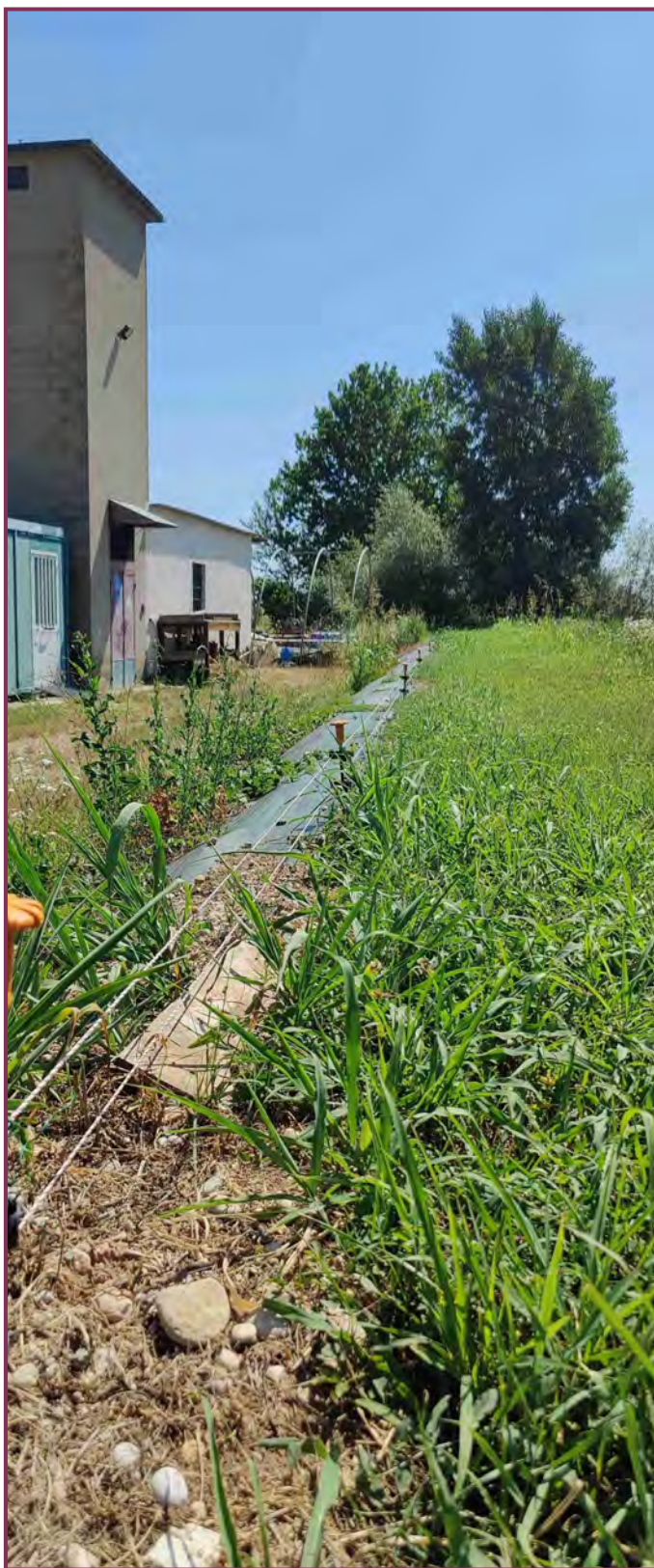
Figura 5. Fili del circuito elettrico, posizionati rispettivamente a 10 cm e 20 cm dalla superficie del terreno (foto di A. Riviera).
