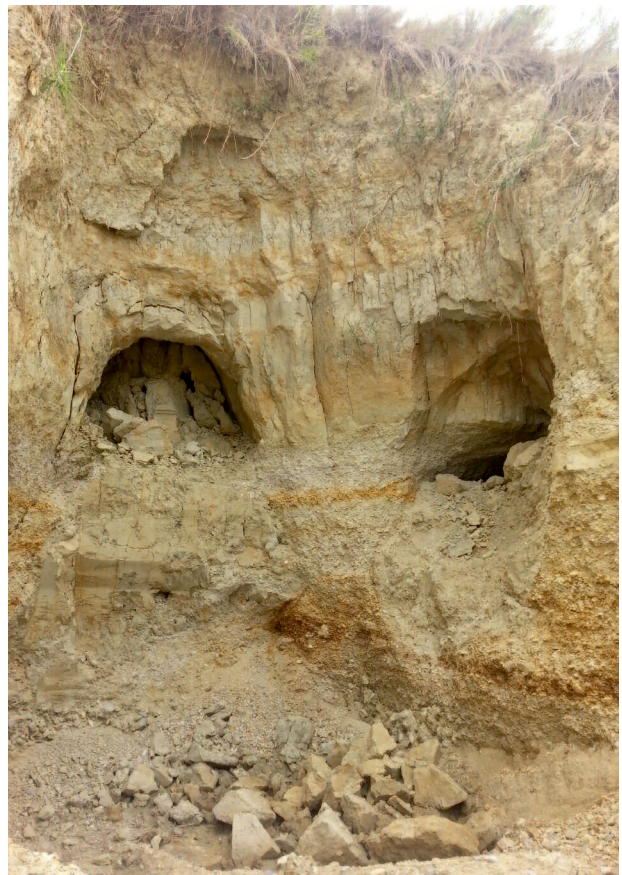
Fig. 19 – Gallerie di coltivazione delle sabbie e ghiaie presso Via delle Vigne. - Galleries of cultivation of the sands and gravels near Via delle Vigne.
