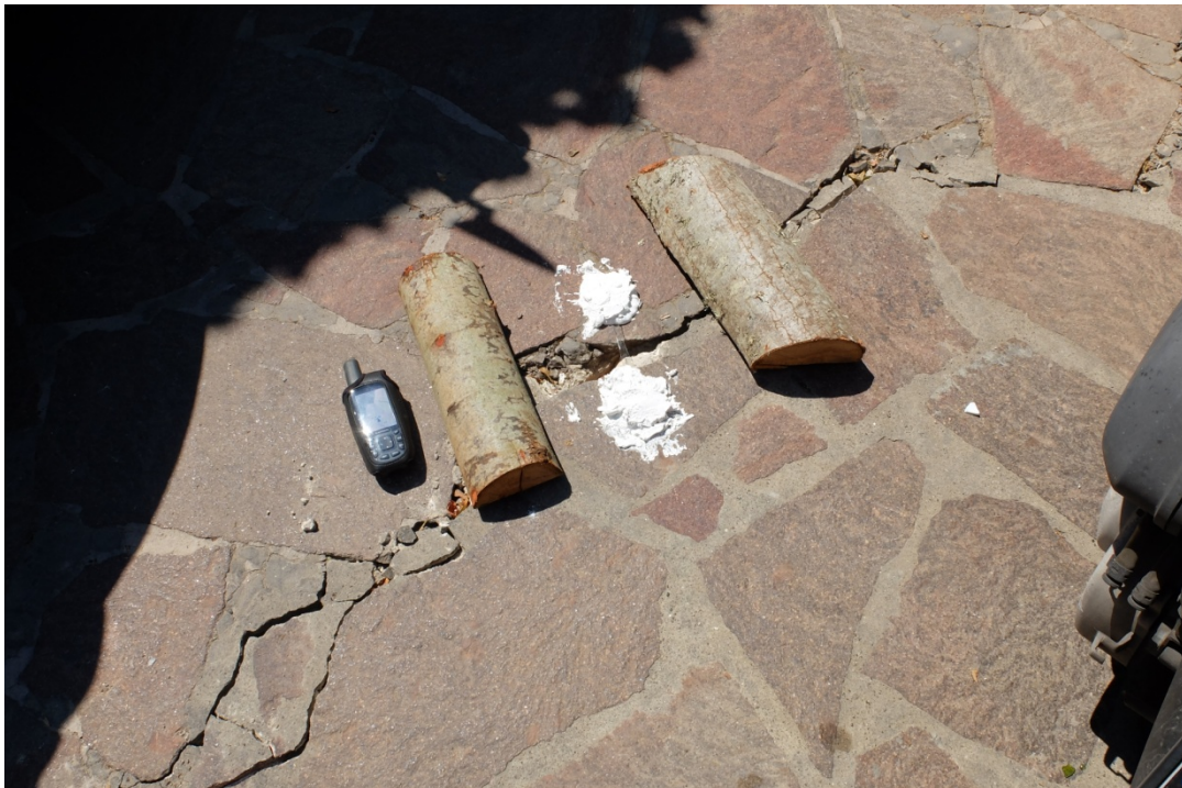
Figura 8 - Uno dei vetrini artigianali posizionati per il monitoraggio della frattura presente sul piazzale della casa ad W di via Crateca, al Wp.289.
