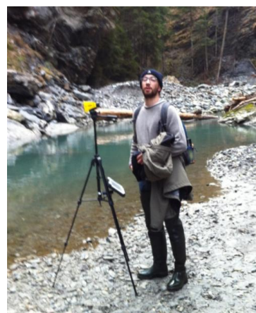
Figura 2.7 – (Immagine di sinistra) Computer da campo o tablet di tipo rugged Algiz 10X (Handheld). (Immagine di destra) Installazione dello stesso su cavalletto fotografico amagnetico assieme al telemetro laser Trupulse 360B (in foto: Ing. Matteo Facchini, ETH (Zurich), durante i rilievi idromorfologici sul Fiume Albula, Svizzera).
