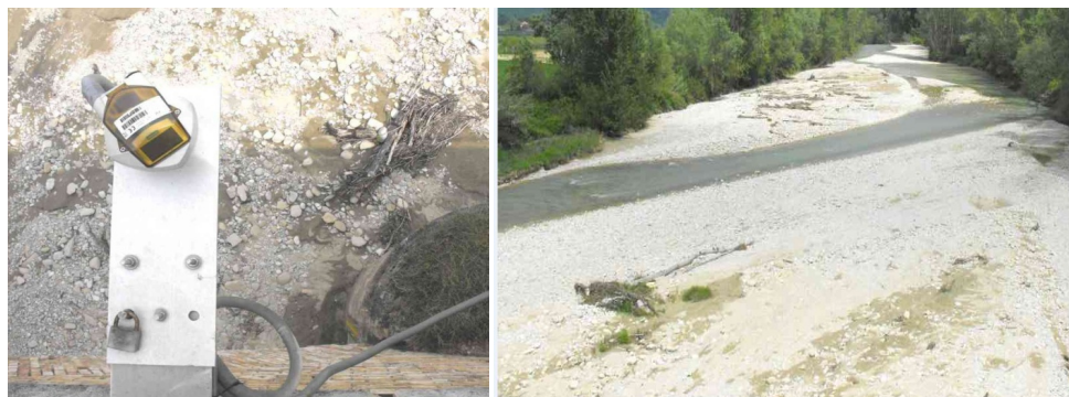
Figura 8.14 – Alveo a carattere torrentizio in fase di magra: il flusso d'acqua divagando rende inutilizzabili i dati letti dal sensore idrometrico.
