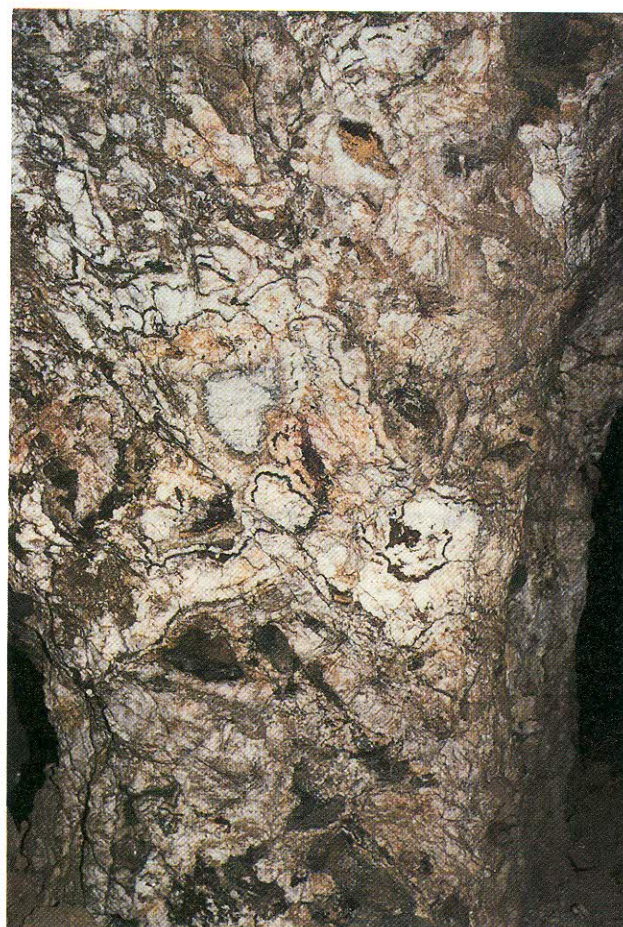
Fig. 4. – Miniera di San Giovanni, Massa Peloggio: pilastro con mineralizzazione «Ricchi Argento» a coccarde con calcite, barite, quarzo e galena argentifera.
