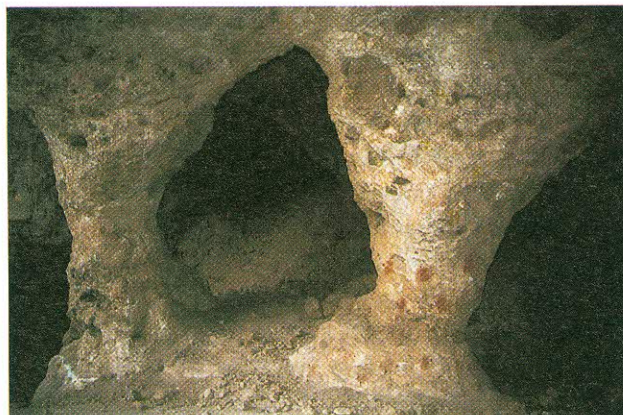
Fig. 6. – Miniera di Barbusi: pilastri mineralizzati a barite che sostengono la volta della grande camera sotterranea.
