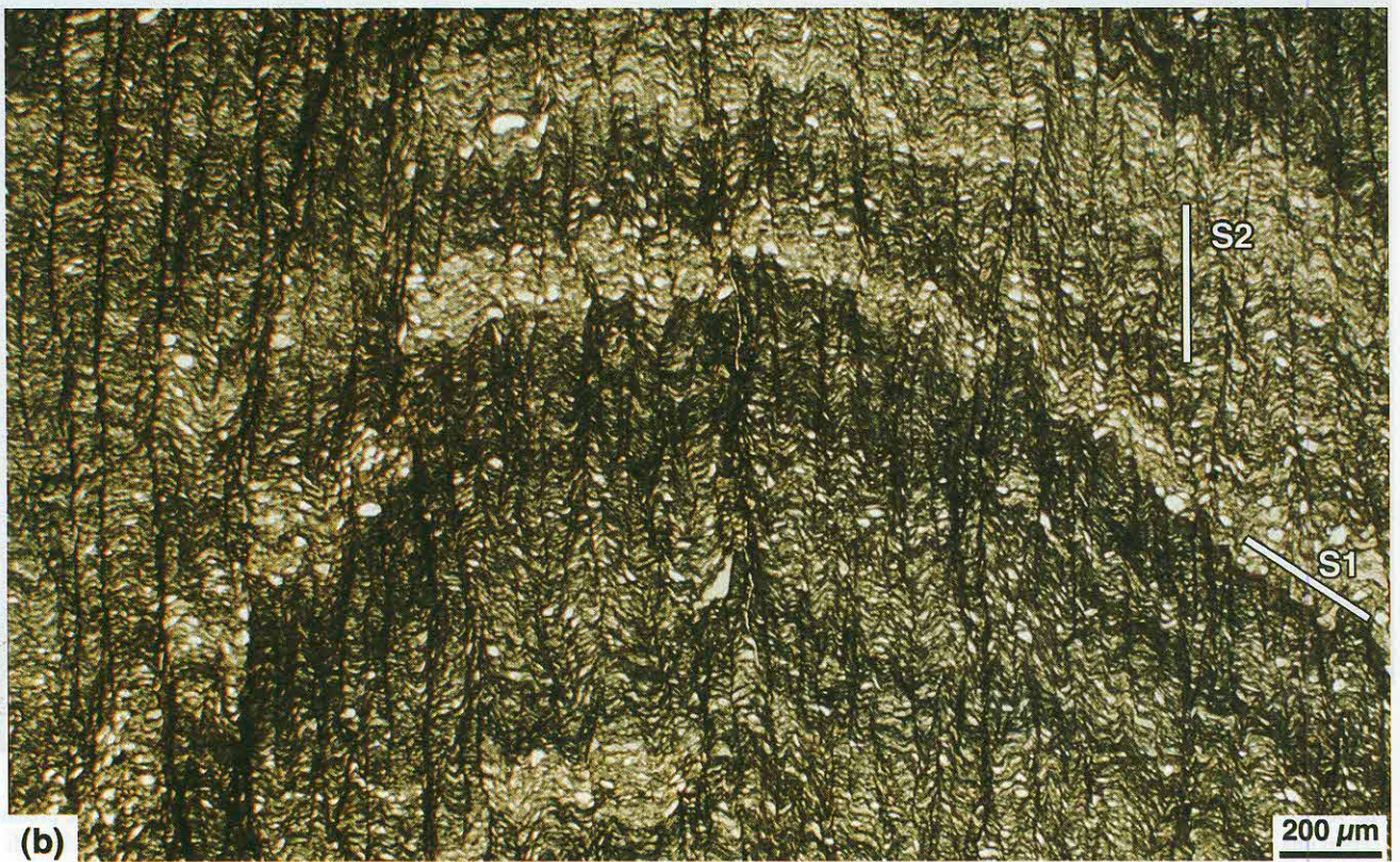
Fig. 99 - (a) Piega asimmetrica che ripiega la scistosità S1 di prima fase ercinica (formazione devoniana degli "Scisti a tentaculiti"; Riu S'Acqua Callenti, Sarrabus). (b) Scistosità di crenulazione S2 (verticale nella foto) in cerniera di una piega D2. La scistosità piegata è la scistosità S1 di prima fase (Villasalto: Gerrei).
