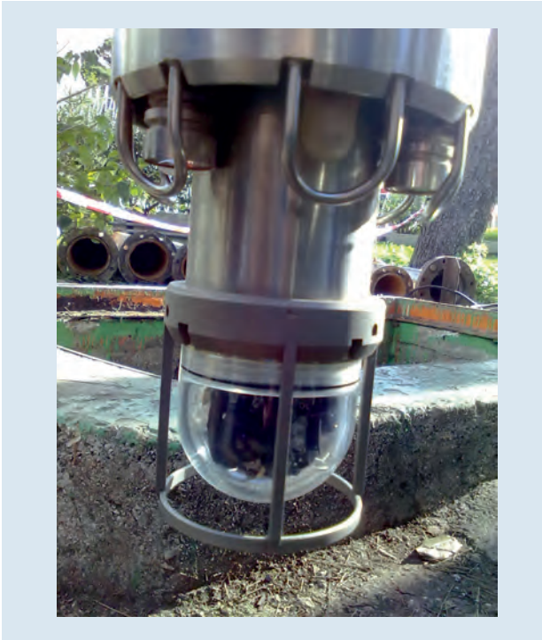
Fig. 9.38 - Particolare della telecamera utilizzata per le ispezioni televisive in foro.
