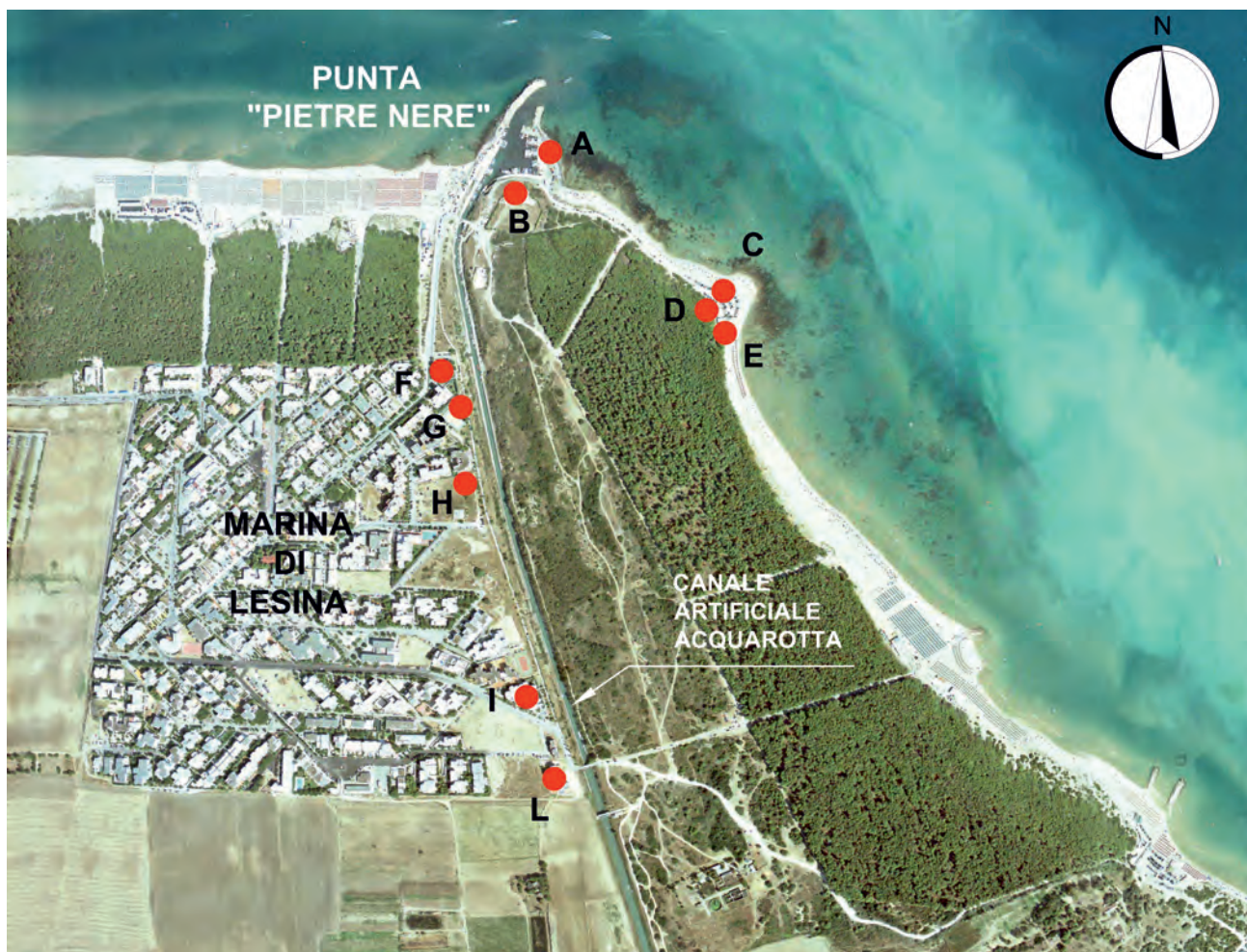
Fig. 13.29 - Posizioni dei PS (Permanent Scatterers) che hanno permesso di acclarare un concentrato uplift nell'area di Marina di Lesina attraverso la tecnica dell'interferometria radar.
