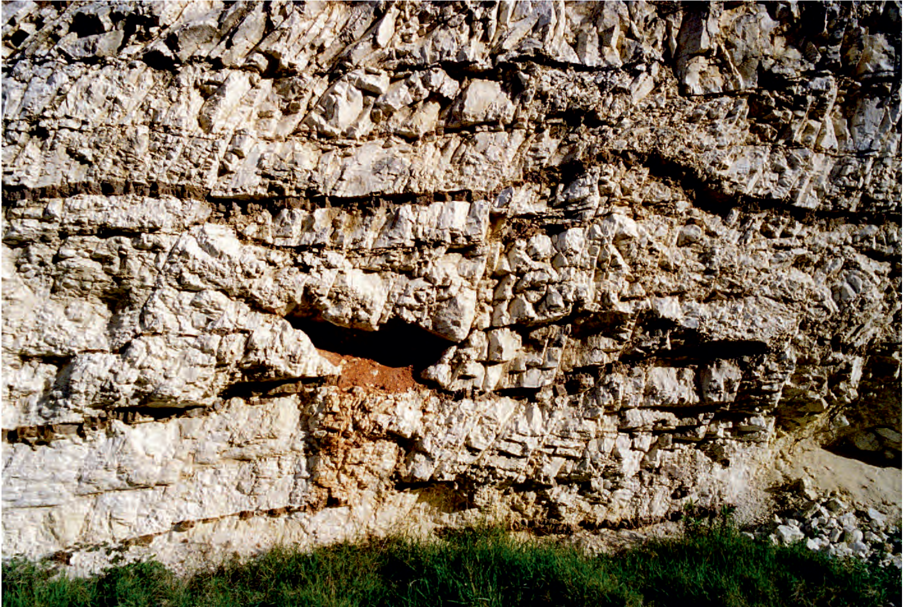
Fig. 13.38 - Calcari a Maiolica, densamente fratturati e tettonizzati, con alternanza di liste di selci, interessati da un raro affioramento di Terre rosse entro una cavità carsica lungo la SP. 53 Mattinata-Vieste.
