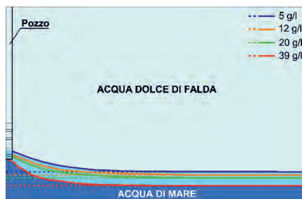
Fig. 15.85 - Distribuzione della concentrazione salina dell'acqua durante l'emungimento calcolato con il codice di calcolo SUTRA 2D3D.1 per il pozzo Monopoli 10.
