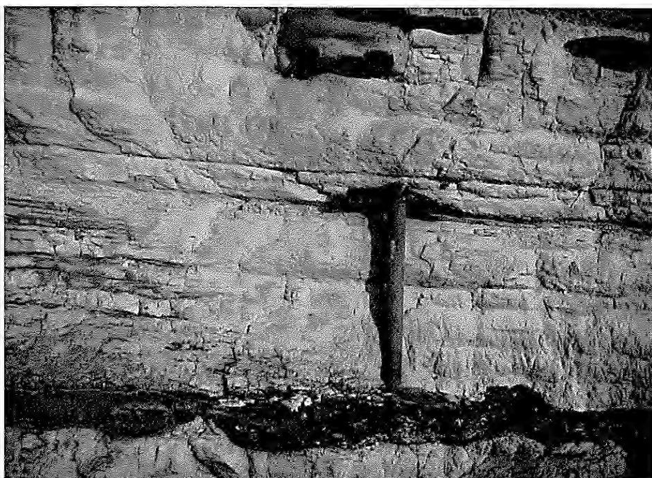
Fig. 8 — Calcari bianchi a grana fina con selci, sulla Strada Statale fra Peschici e Vieste; in questo punto la roccia è praticamente impermeabile.
