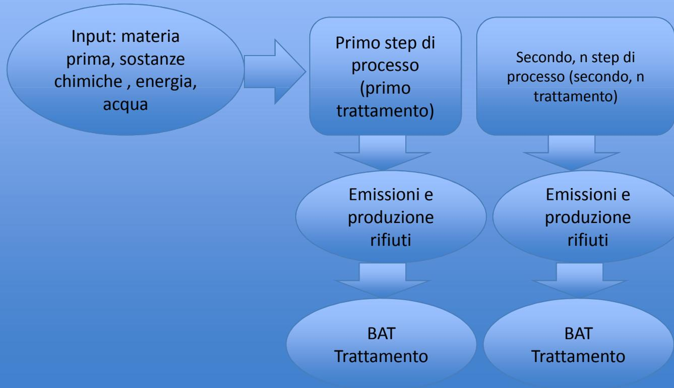
**In ogni step di processo è preferibile tralasciare l'analisi delle tecniche end of pipe a favore delle tecniche che contribuiscono alla fonte alla non produzione della sostanza inquinante/contaminante**
