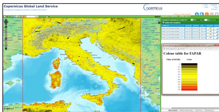
Figura 5. Esempio di mappa di fAPAR con risoluzione 1 km (zoom sull'Italia) per l'ultima decade di febbraio 2017 prodotte utilizzando i dati giornalieri PROBA-V nell'ambito del Copernicus Global Land Service (Fonte: Copernicus).
