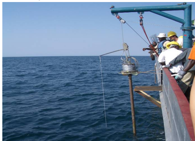
Figura 46. Esempio di carotiere a pistone (foto http://www.geo.arizona.edu/ ).
