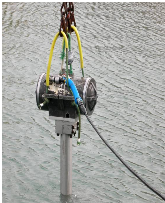
Figura 44. Esempio di vibrocarotiere, mod. Rossfelder® (foto Elena Romano, ISPRA).
