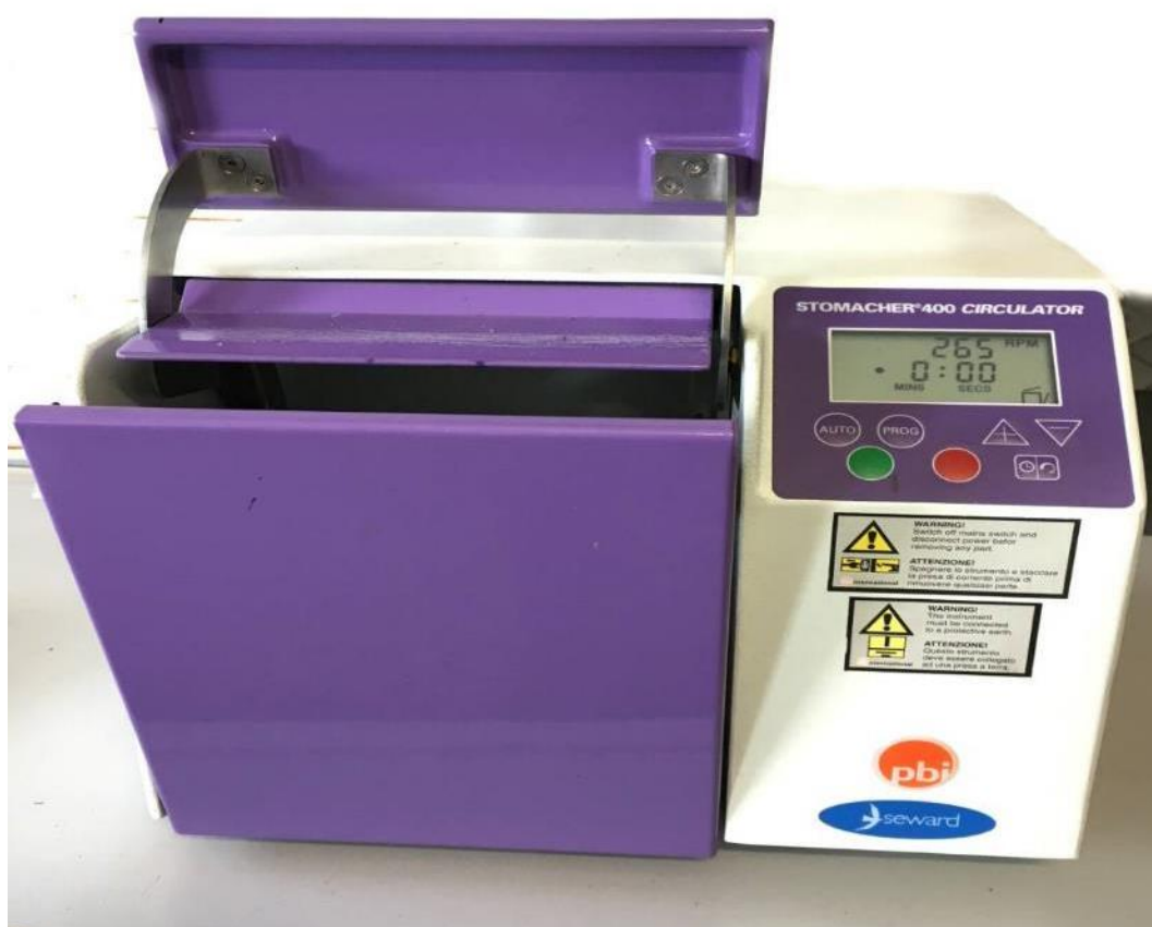
Figura 28. Omogeneizzatore da laboratorio “Stomacher® 400 Circulator” 34 [Foto: G. Attili - © - Archivio GMEM - AMB]
