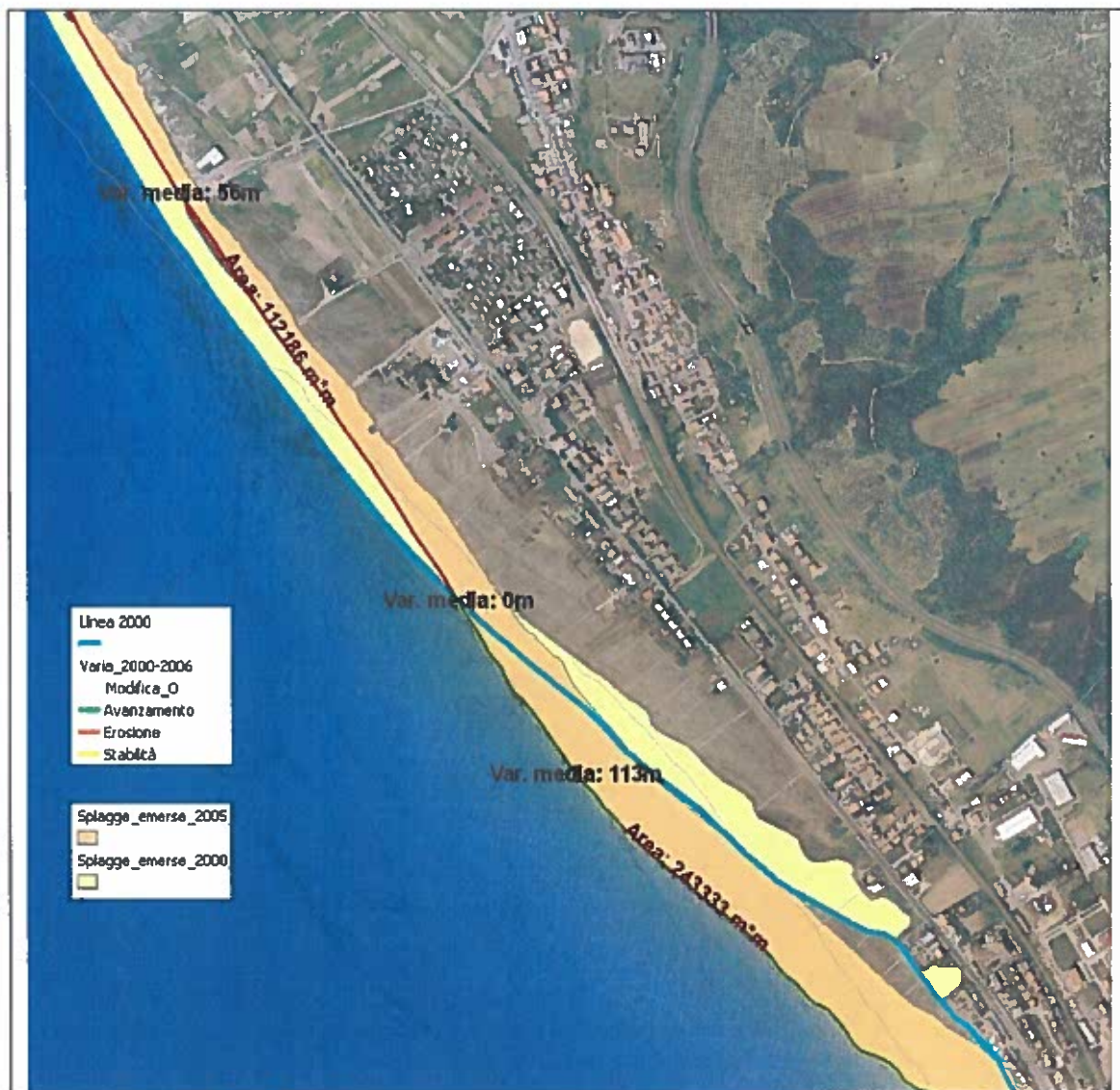
Figura 6. Rilevazione delle variazioni geomorfologiche mediante sovrapposizione dell'assetto delle linee di riva e delle spiagge: a nord arretramento medio di 56 m e 112.186m 2 di superficie erosa, a sud avanzamento medio di 113 m e 243.333m 2 di superficie in progradazione. (Calabria)
