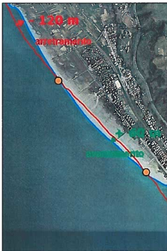
Figura 5. Esempio di rilevazione delle modifiche, con indicazione del tipo e del valore massimo della variazione. In rosso la "Linea di riva 2000" e in azzurro la "Linea di riva 2006" su ortofoto del volo IT2006. (Calabria)
