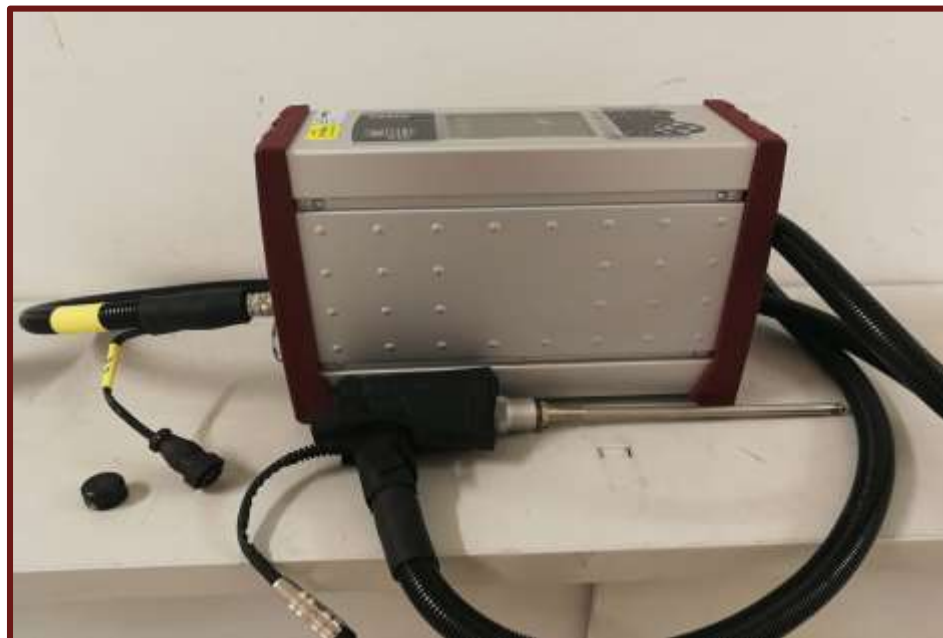
UNI EN 14789 Paramagnetico per O 2 Celle IR ISO 12039:2001 per CO 2
