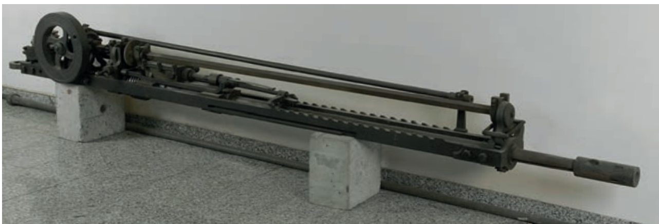
Macchina perforatrice Sommeiller secondo modello (1862). Dipartimento di Ingegneria dell'Ambiente, del Territorio e delle Infrastrutture del Politecnico di Torino. In questo modello, come nella grande maggioranza delle successive perforatrici, per mezzo di un cassetto di distribuzione, l'aria compressa produceva il movimento alternativo di uno stantuffo che agiva su un fioretto percussore. Mediante un motorino indipendente si ottenevano l'avanzamento e la rotazione periodica del fioretto. Questo secondo modello, versione semplificata e molto irrobustita del primo, entrò in attività nel 1863. Foto Studio Gonella.
