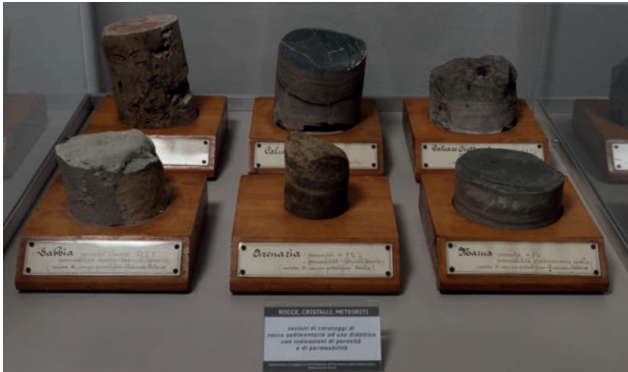
Sezioni di carotaggi di rocce sedimentarie ad uso didattico con indicazione di porosità e di permeabilità. Dipartimento di Ingegneria dell'Ambiente, del Territorio e delle Infrastrutture del Politecnico di Torino. Foto Roberto Appiani.
