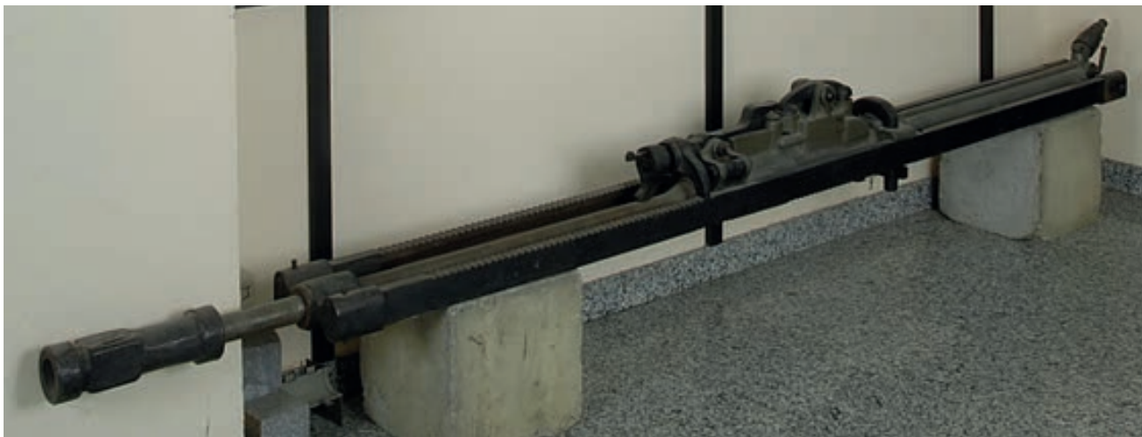
Macchina perforatrice Ferroux ultimo modello (1870 circa). Dipartimento di Ingegneria dell'Ambiente, del Territorio e delle Infrastrutture del Politecnico di Torino. Derivata dal secondo modello della perforatrice Sommeiller del 1862, fu utilizzata per il traforo dell'Arlberg tra Austria e Svizzera (1880-1884) e per quello svizzero del San Gottardo (1872-1882). Questa perforatrice eseguiva nel granito un foro di 40 mm di diametro e un metro di lunghezza in 1 ora e 9 minuti (contro le quasi tre ore della perforatrice di Sommeiller). Foto Studio Gonella.
