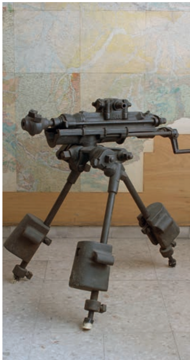
Supporto a treppiede e perforatrice pneumatica Ingersoll (sergeant A35), anno 1894. Dipartimento di Ingegneria dell'Ambiente, del Territorio e delle Infrastrutture del Politecnico di Torino. Foto Studio Gonella.
