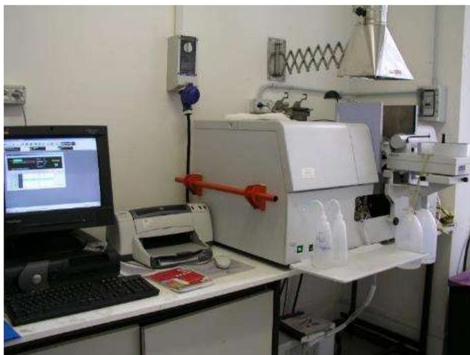
*Figura 718. Spettrofotometro ad assorbimento atomico
