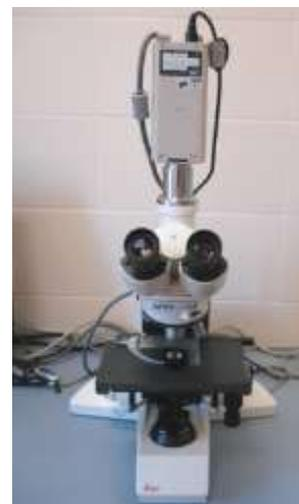
*Figura 700. Sistema di acquisizione delle immagini Leica DM LB*
