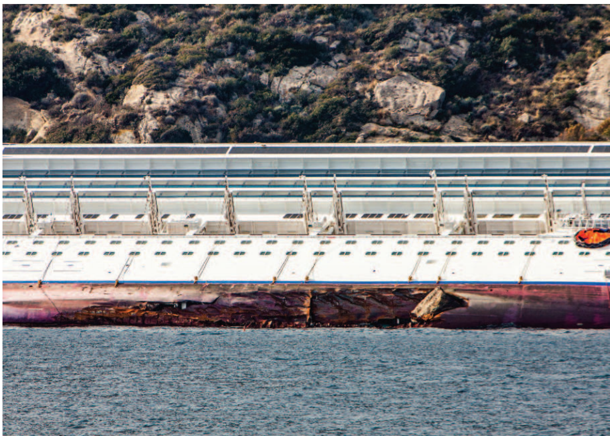
Figura 5.4: Il blocco di granito del peso di circa 200 tonnellate rimasto incastrato nello scafo dopo l'urto con gli scogli delle Scole.
