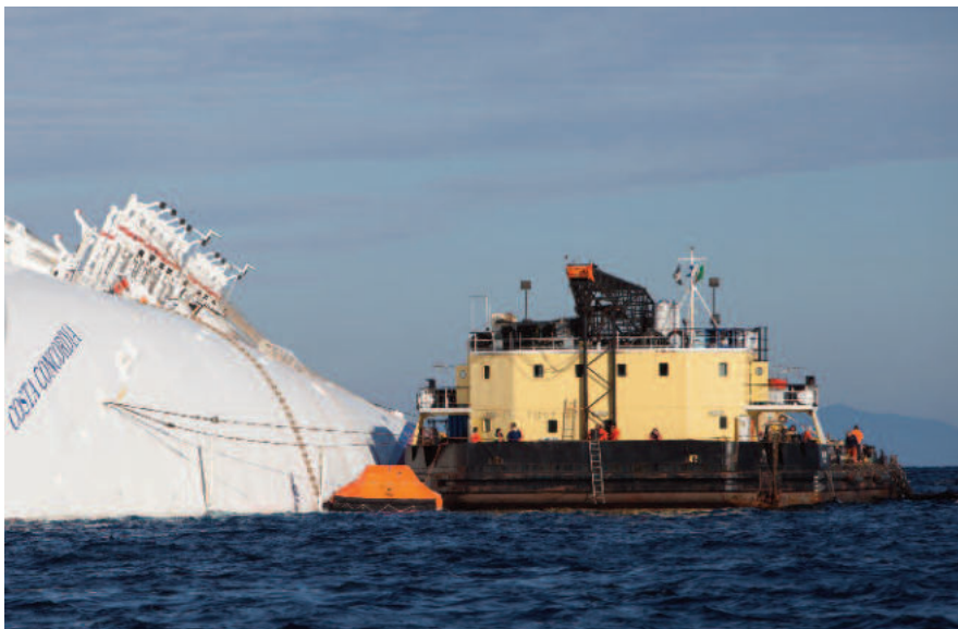
Figura 5.12: Il sistema di allerta durante la messa in sicurezza prevedeva che in presenza di un'onda significativa (ortogonale allo scafo) maggiore di 1,5 metri e di spostamenti dello scafo superiori a 2 cm/ora, il personale sul relitto o nelle vicinanze dovesse evacuare.
