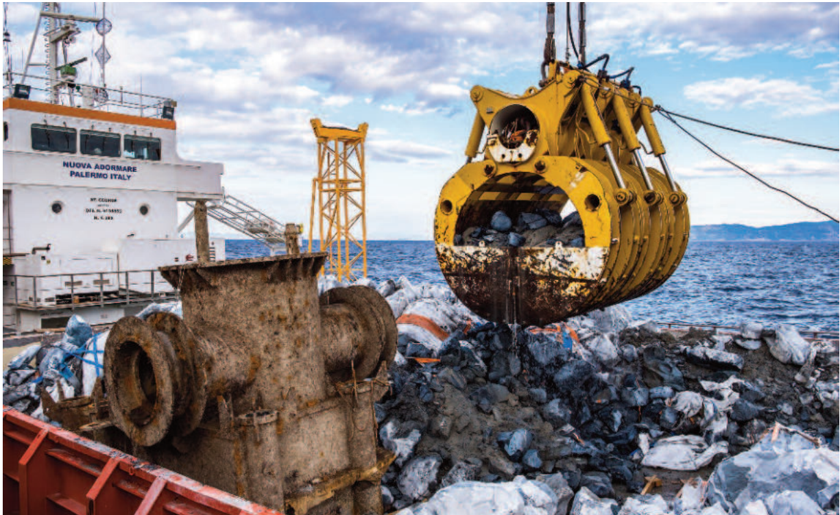
Figura 8.6: Materiale recuperato dalla benna e stoccato prima dello smaltimento. In parte è stato riutilizzato per le opere di ampliamento del porto di Piombino.
