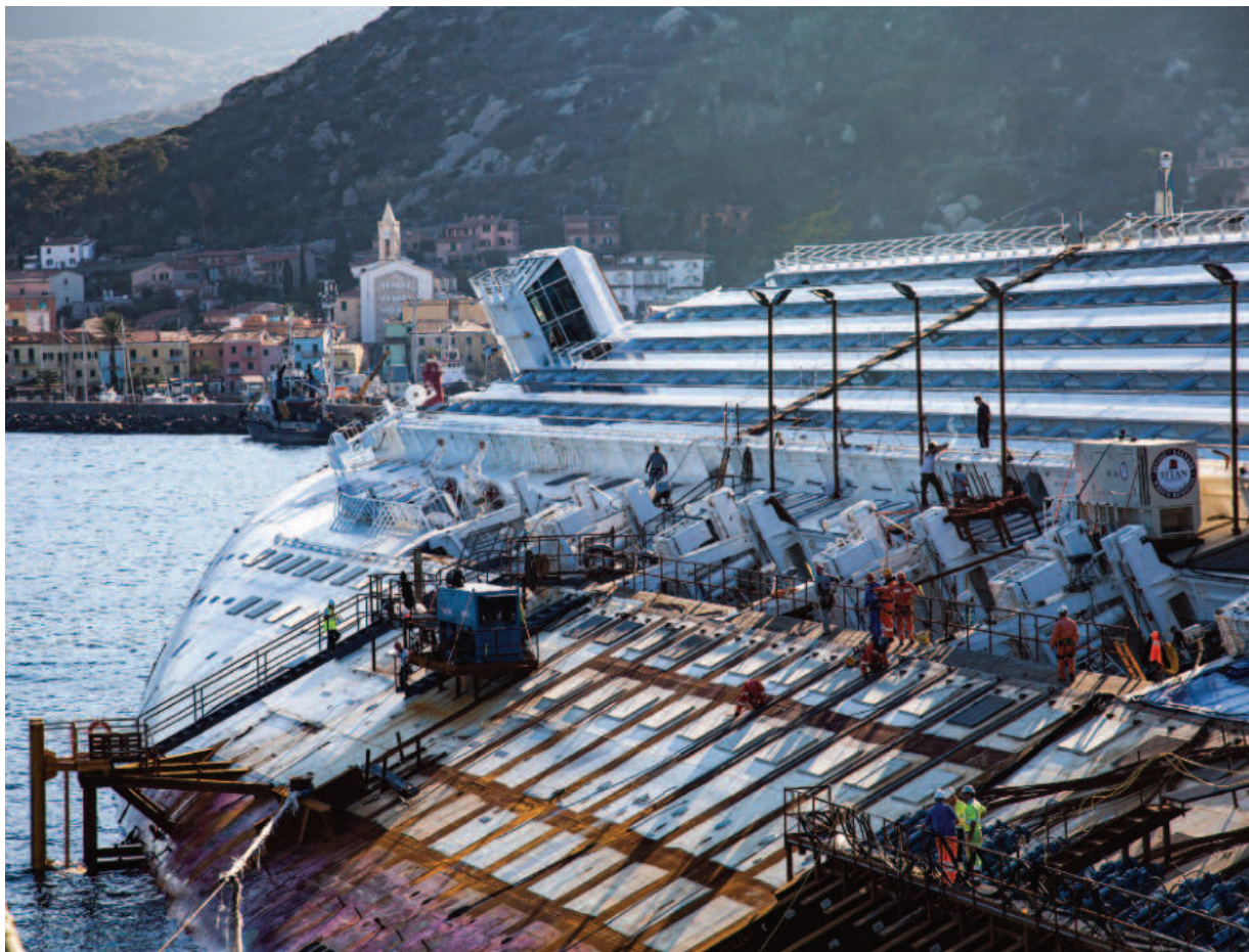
Figura 6.5: Operazione di aggancio dei cavi d'acciaio sul lato sinistro della nave.
