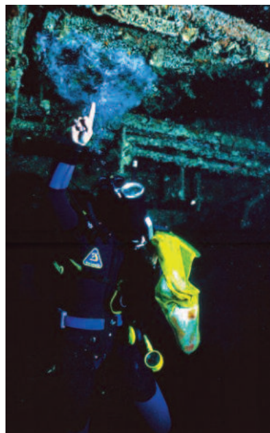
Figura 3.2: I residui di idrocarburi contenuti nel relitto hanno causato inquinamento anche anni dopo l'affondamento della VLCC "HAVEN" (Arenzano, GE, 1991). Nelle immagini, il metodo impiegato per stimare la necessità di aspirare i residui liquidi accumulatisi a cielo dei locali dei ponti superiori della superpetroliera. (Foto Ezio Amato).
