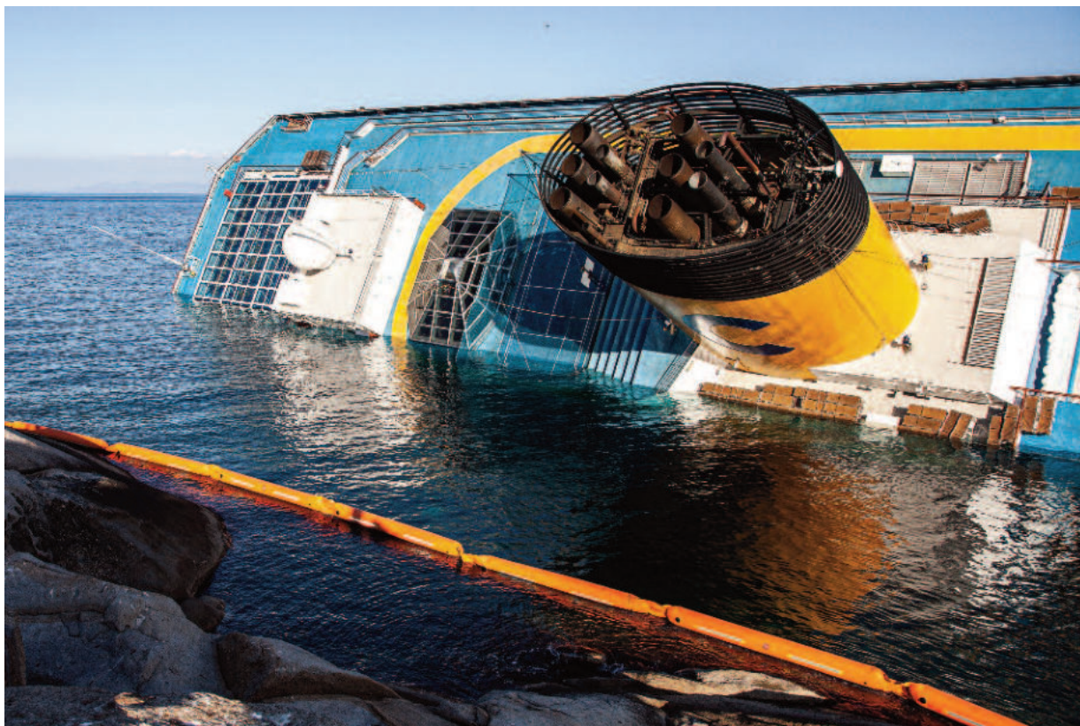
Figura 5.9: Secondo le disposizioni del "Piano antinquinamento da idrocarburi" approvato dal Comitato tecnico-scientifico, intorno al relitto erano state posizionate panne di contenimento atte a permettere l'eventuale recupero di idrocarburi sversati mediante strumenti chiamati skimmer.
