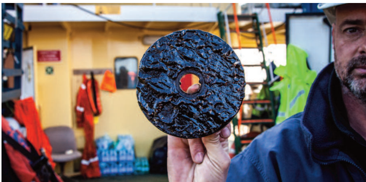
Figura 5.13: Parte di un serbatoio della Concordia tagliato per praticare il foro per il recupero del combustibile. Si noti come l'IFO 380 rimanga adeso alla superficie metallica senza colare.
