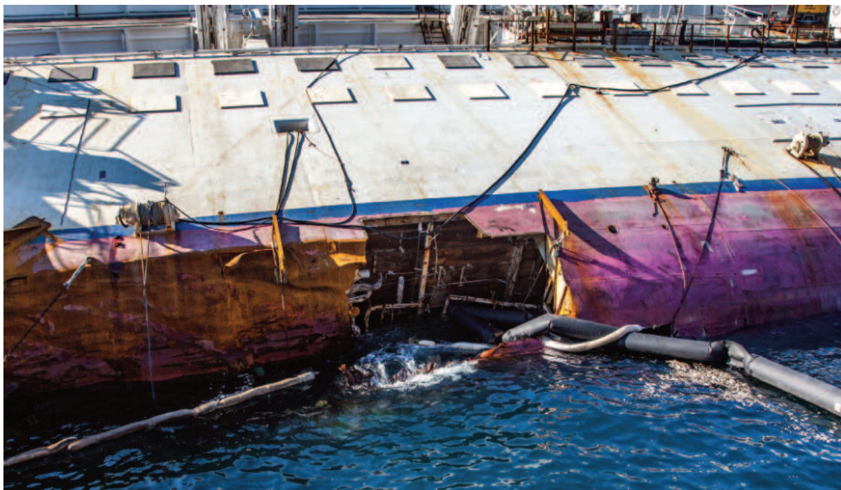
Figura 7.1: Le cisterne contenenti il combustibile sono posizionate immediatamente sotto lo squarcio, lungo la chiglia.
