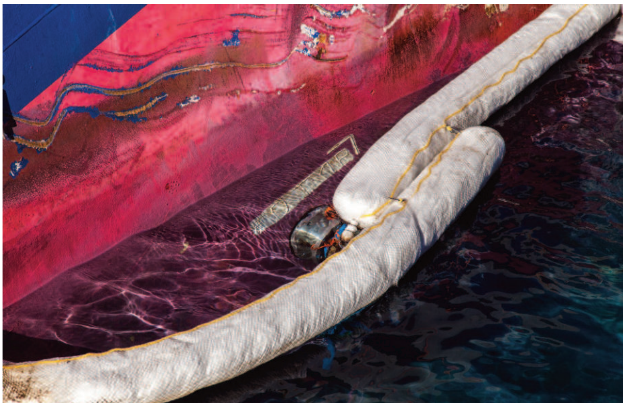
Figura 5.15: A circa 40 cm dalla superficie del mare si osserva l'inserzione dell'"hot tapping" nella chiglia per aspirare il combustibile IFO 380.
