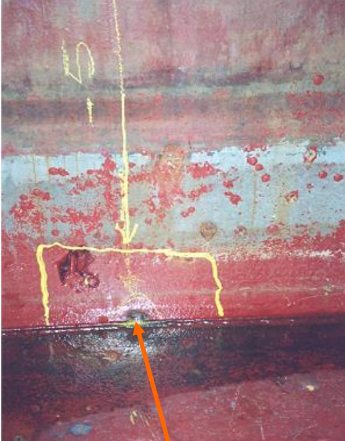
**Corrosione localizzata saldatura
