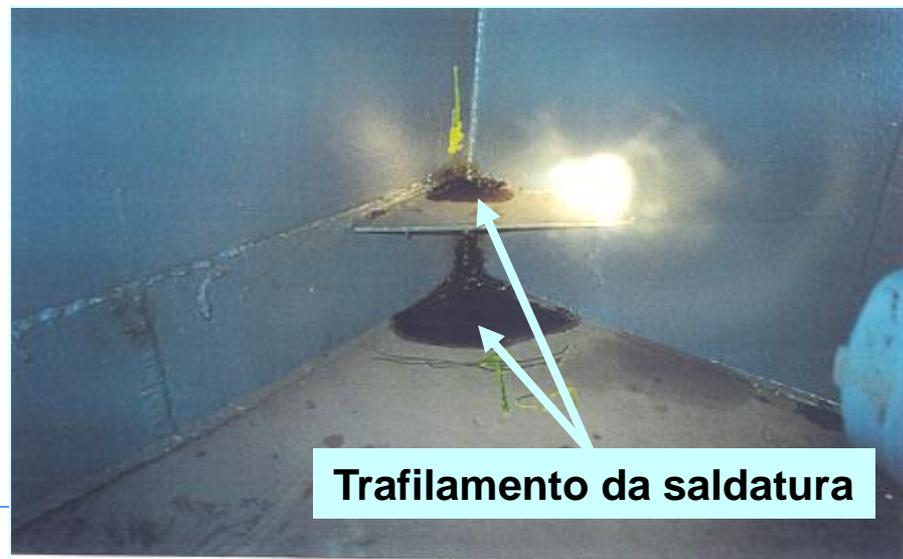
**Trafilamento da saldatura**
