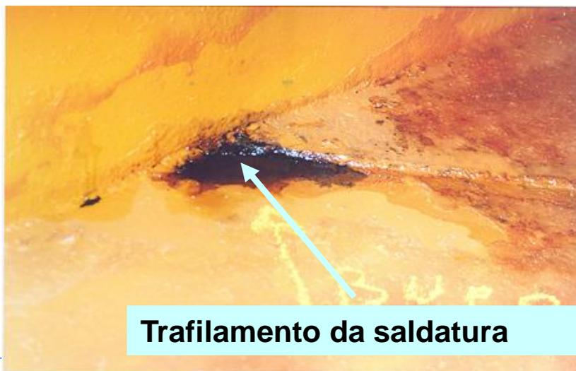
**Trafilamento da saldatura**
