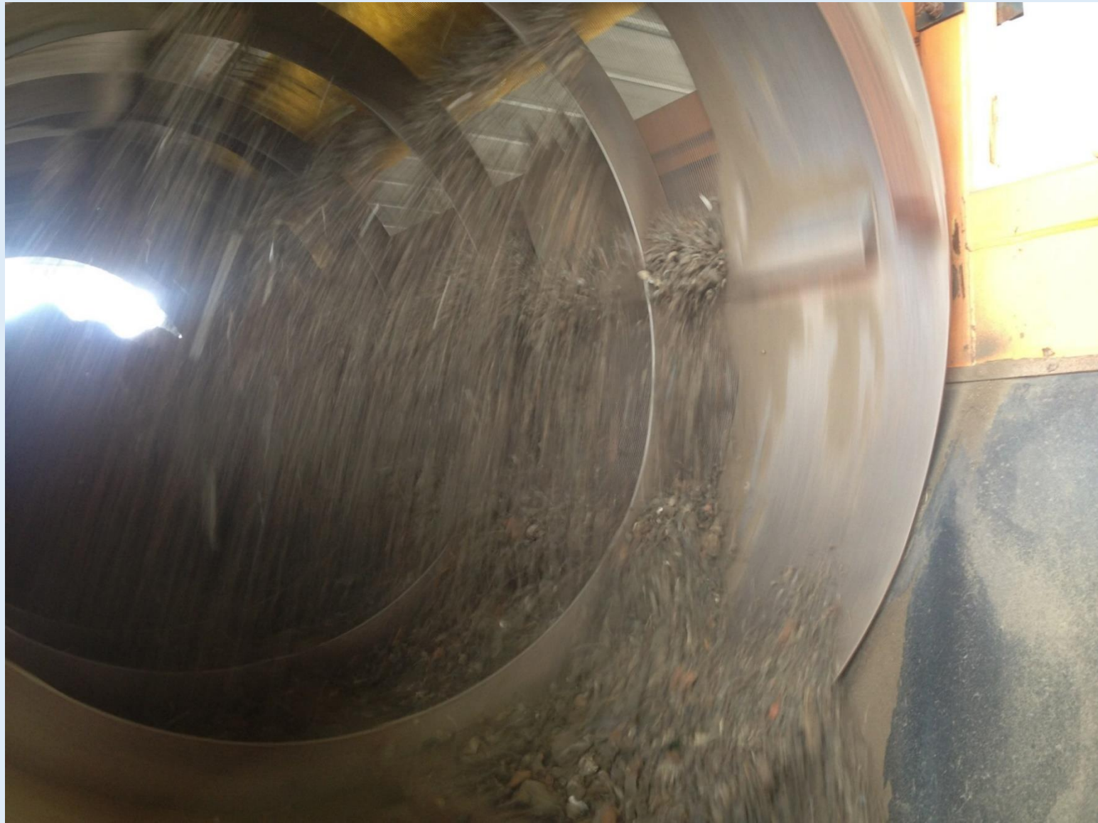
Eventuale vagliatura dimensionale secondaria attuata con vaglio a tamburo Raffinazione della curva granulometrica
