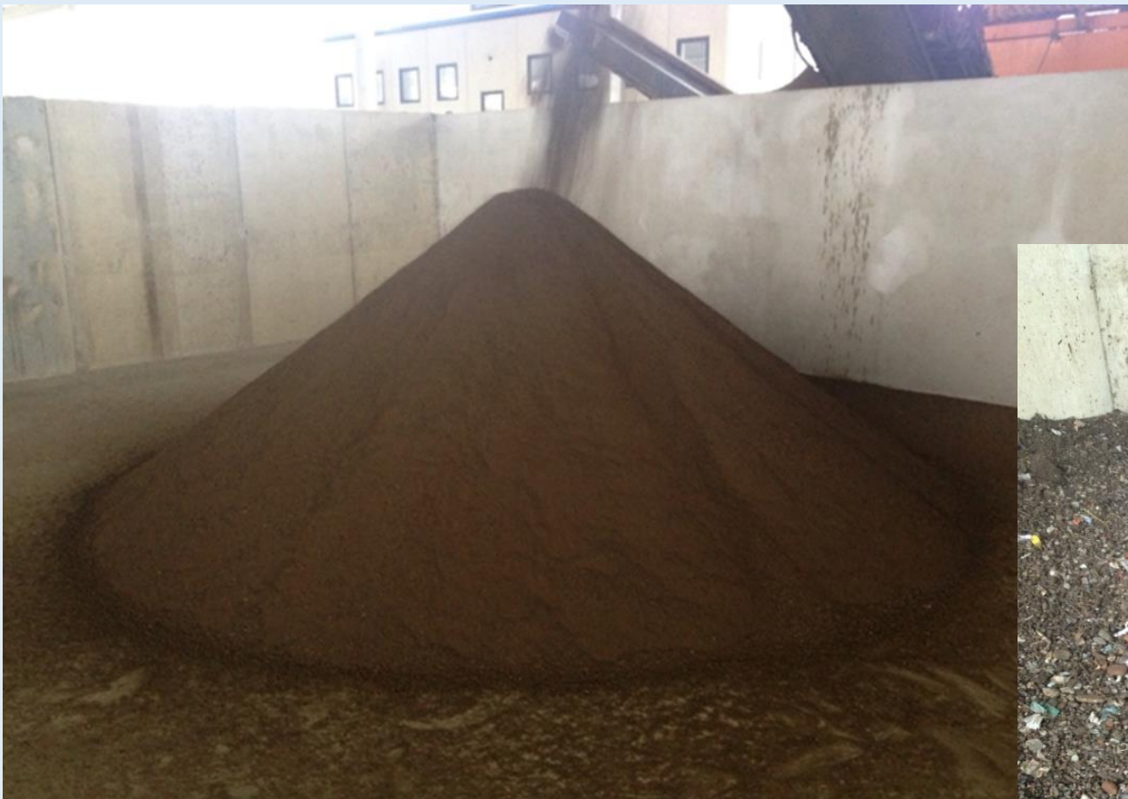
Aggregati artificiali certificati ai sensi della norma tecnica UNI EN 13242 AGGREGATO FINE
