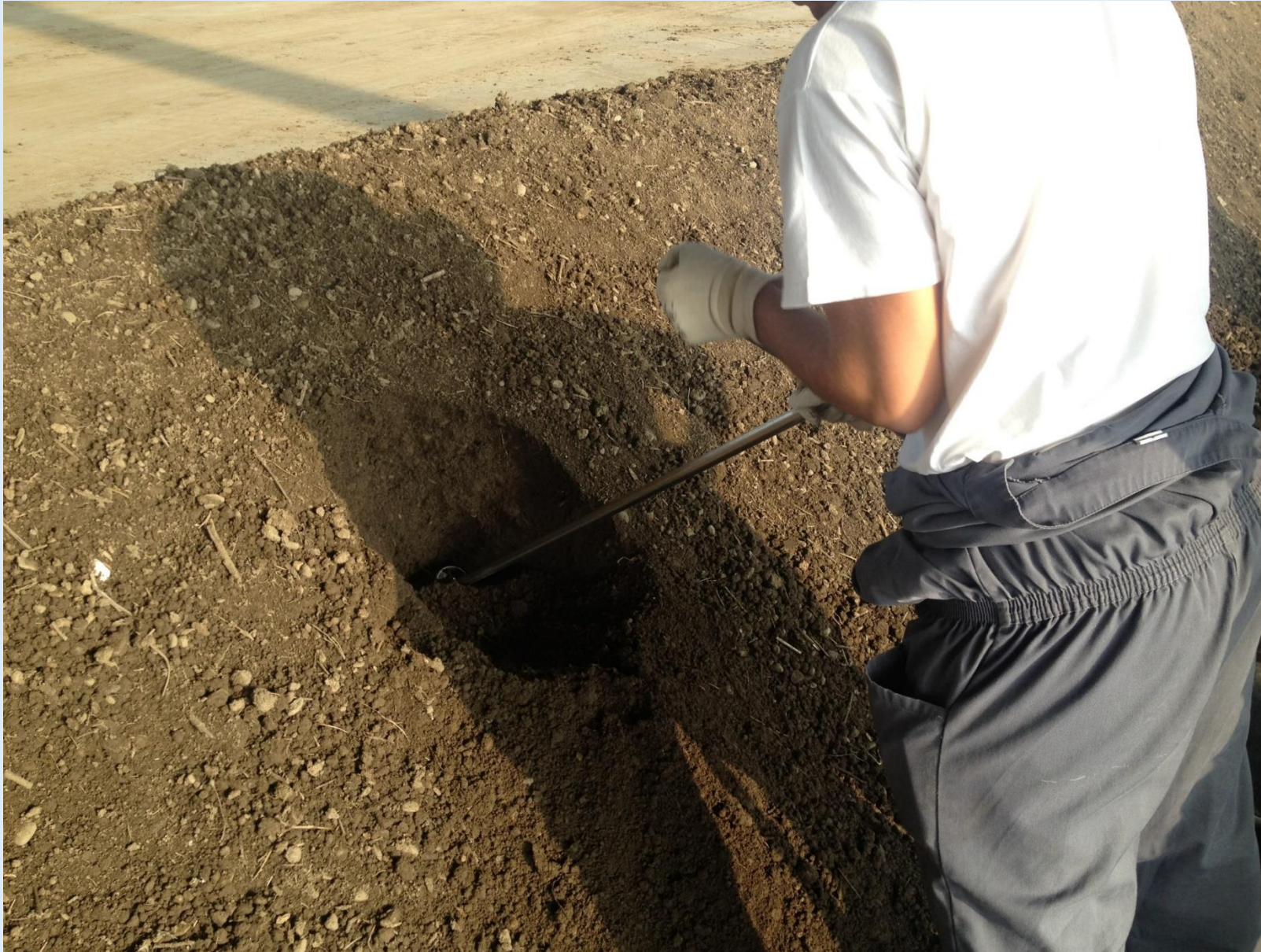
Prelievo di campioni per il monitoraggio periodico dell'andamento di processo
