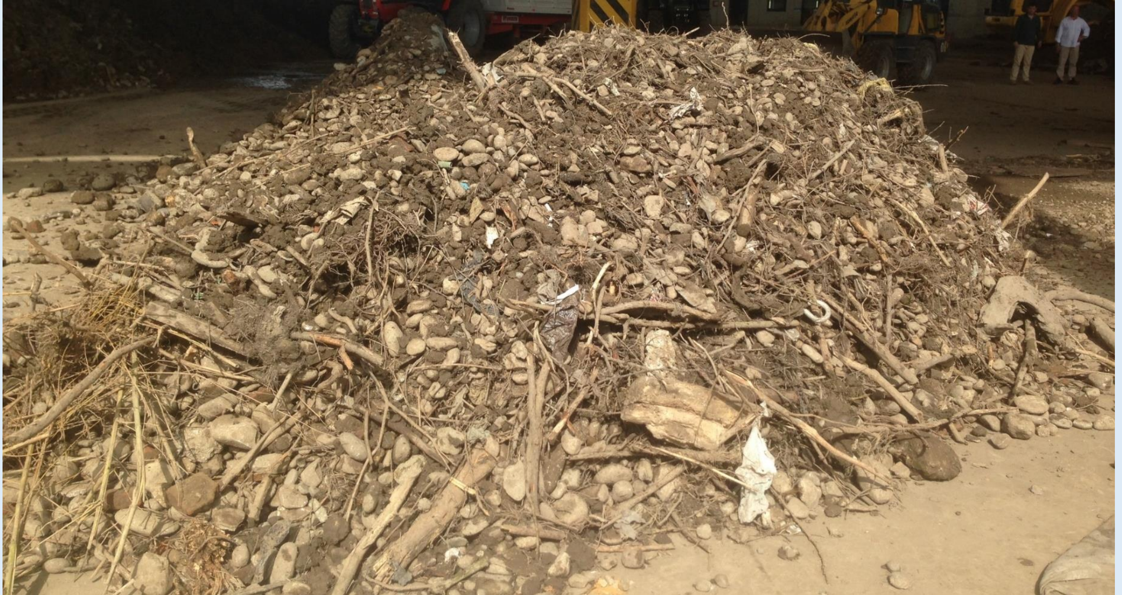
Sopravaglio da vagliatura dimensionale primaria da avviare al processo di raffinazione
