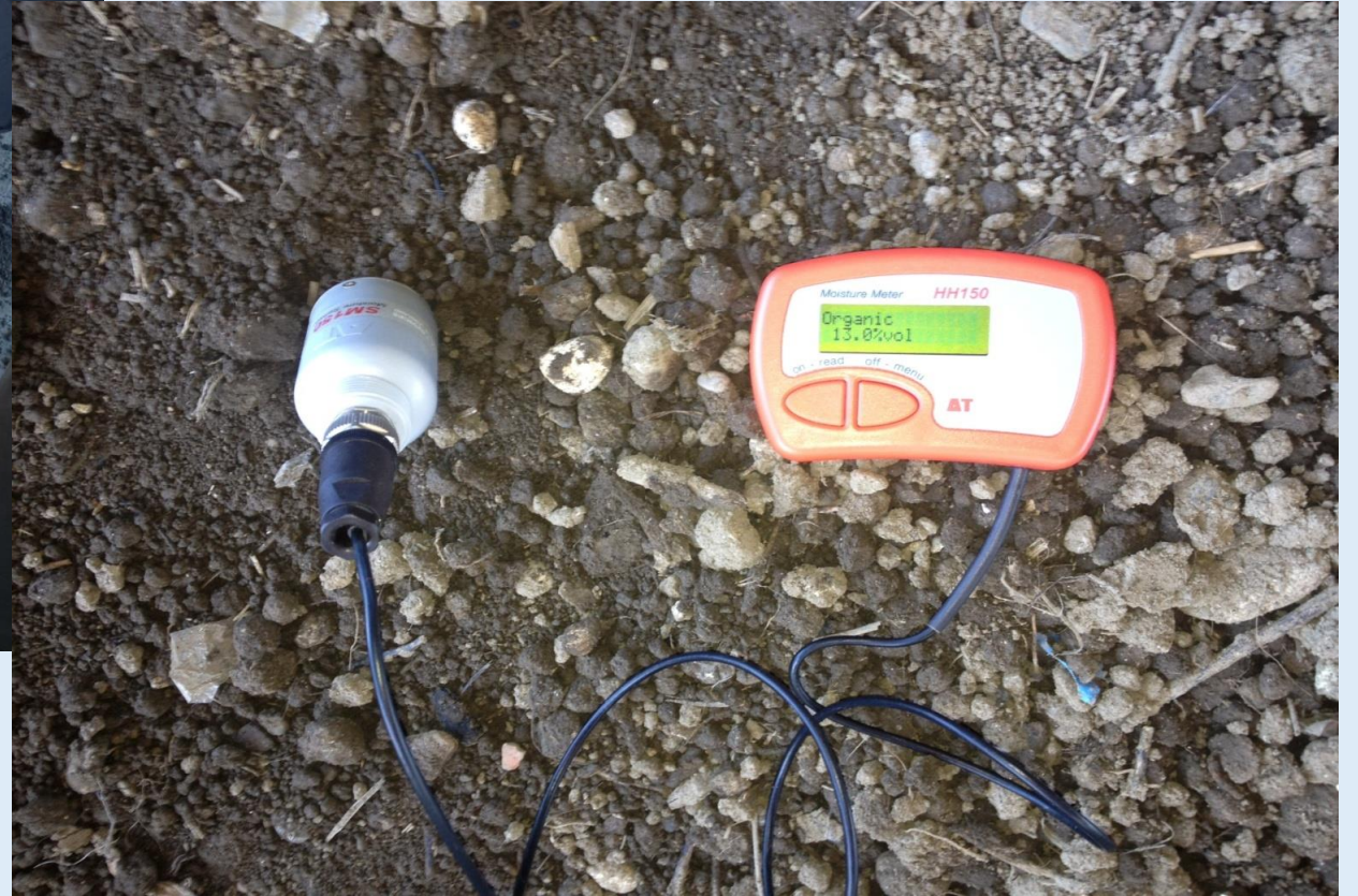
Rilevamento di temperatura ed umidità per monitoraggio periodico dell'andamento di processo
