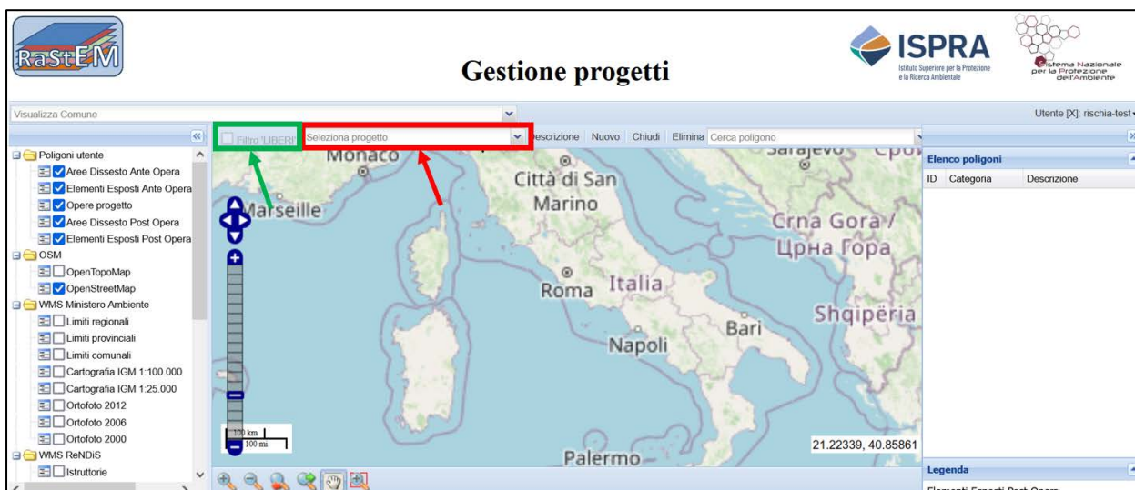
Figura 5-15 - Stringa per la ricerca del progetto creato (riquadro rosso) nella sezione "Gestione progetti". Subito a sinistra, come in "Gestione poligoni", è presente il filtro denominato "Filtro LIBERI" (nel riquadro verde) che, se attivato, consente di visualizzare solo i poligoni assegnati a quel determinato progetto e quelli liberi, ossia non ancora assegnati a progetti RaStEM
