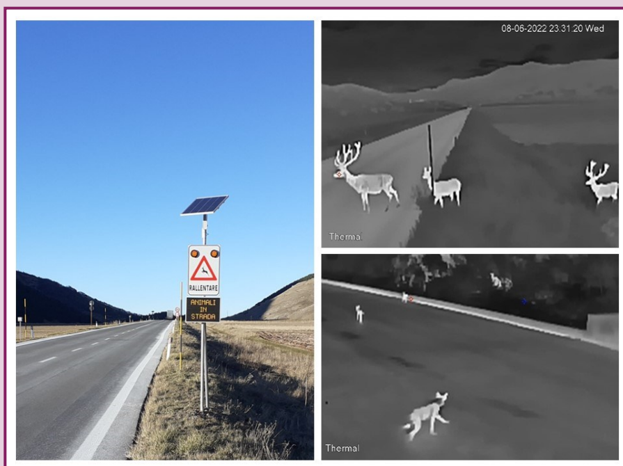
Figura 1. Il sistema di prevenzione degli incidenti stradali con la fauna selvatica (AVC-PS) e le immagini riprese dalla telecamera termica dei sistemi installati in Italia (foto da Archivio Progetto LIFE SAFE-CROSSING).
