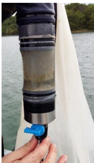
Figura 11: Particolare del bicchiere del retino con cui è stato raccolto il plancton.
