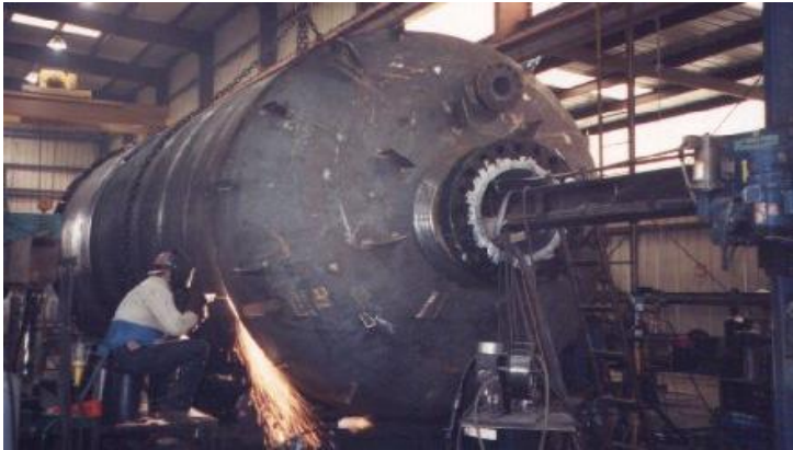
Costruzione di un recipiente a pressione
