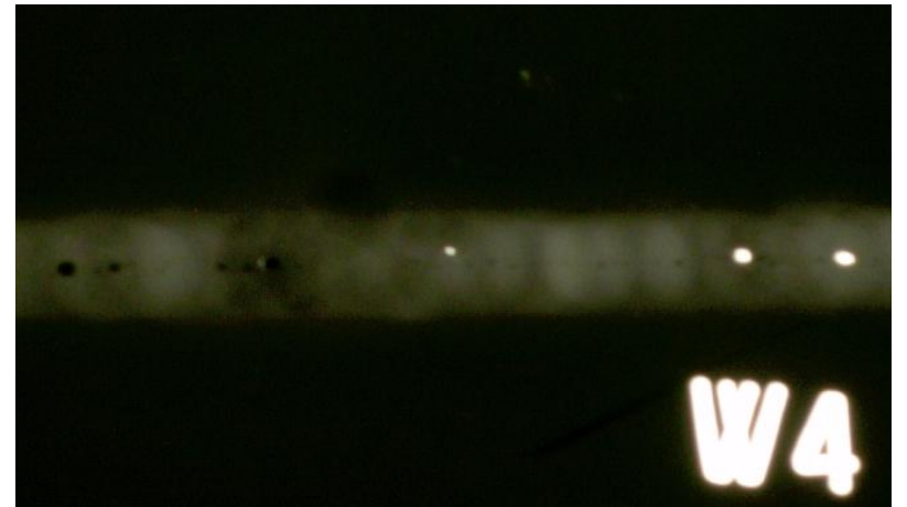
Porosità allineate – inclusioni di tungsteno - controllo RT
