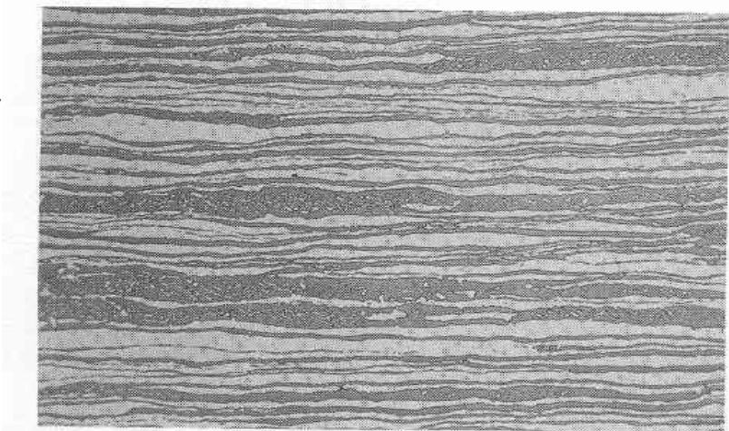
Microstruttura bifasica - acciaio inossidabile austeno ferritico (SAF2205)
