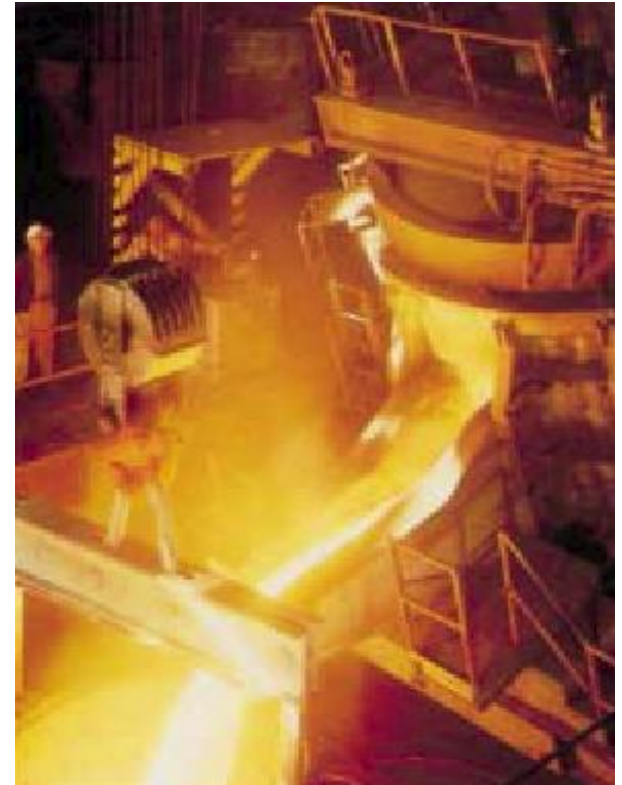
La colata da forno elettrico di una lega di Ni
