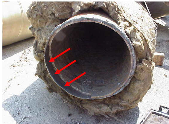
Corrosione AC per sulfidazione a caldo. Linea greggio impianto distillazione atmosferica
