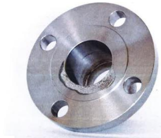
Corrosione interstiziale in flangia
