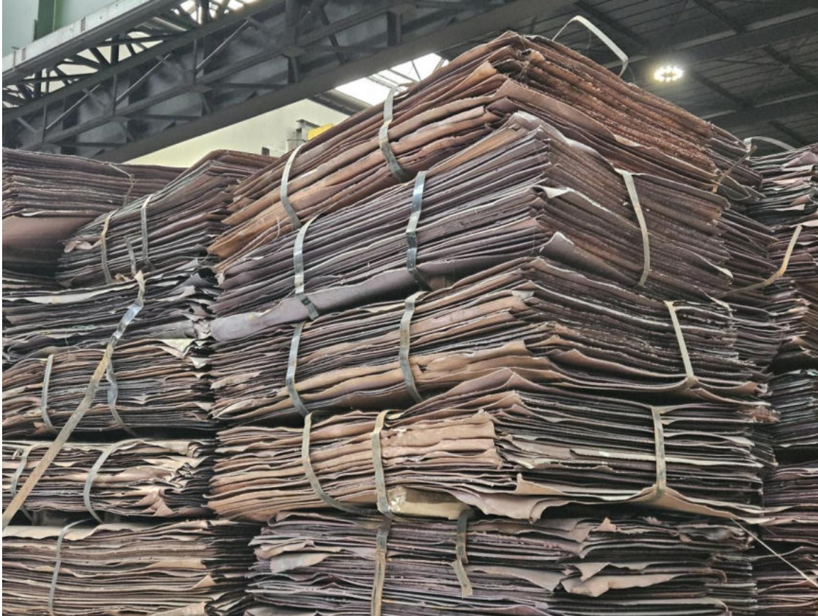
CATODI DI RAME \text{Cu} > 99,9 \%
