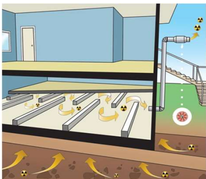
Aspirazione dell'aria con intercapedine, con tubi di drenaggio e con canalina di raccolta
