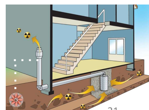
Aspirazione dell'aria con pozzetto interno realizzato centralmente
