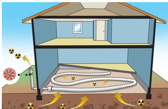
Aspirazione dell'aria con intercapedine, con tubi di drenaggio e con canalina di raccolta
