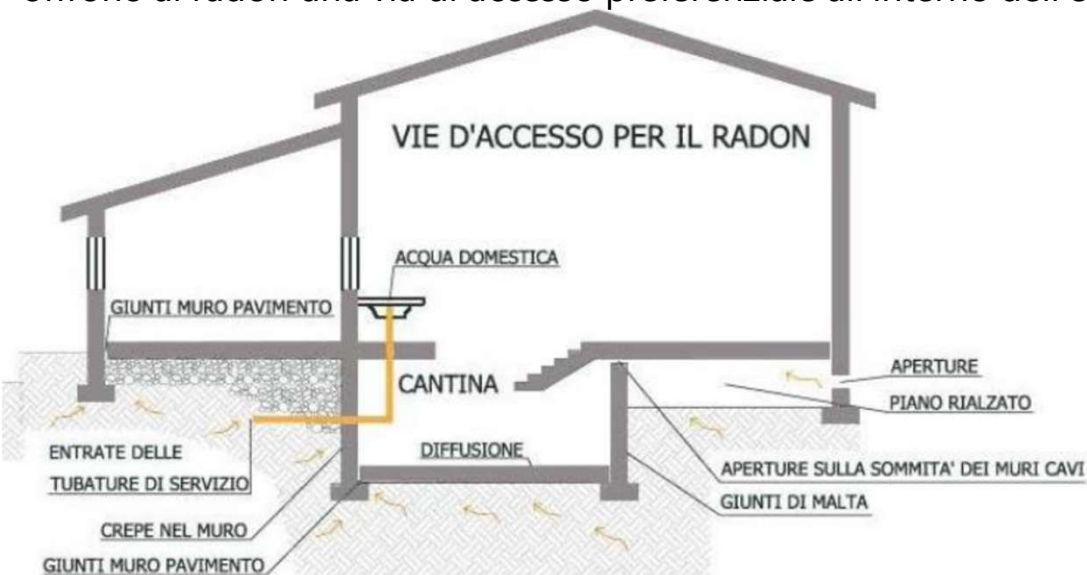
Possibili ingressi di radon dalle canalizzazioni di servizio
