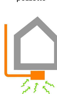
Depressione tramite pozzetto
