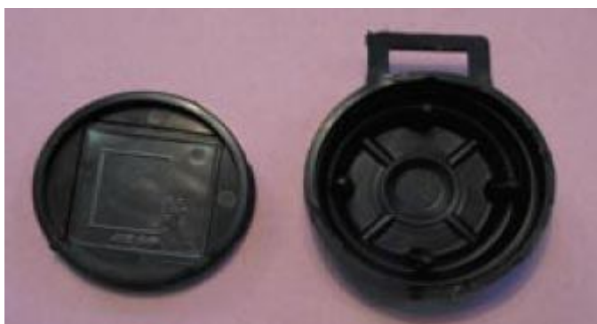
Figura 2.2 - rivelatore CR-39 composto da una lastrina e da una camera di diffusione.
