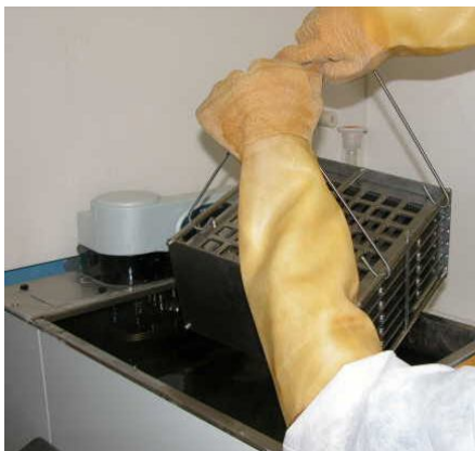
Figura 4.1 – Introduzione delle griglie metalliche contenenti le pellicole CR39
