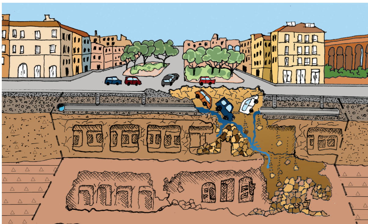
Figura 1 - Sezione geologica schematica del sottosuolo di Roma ed esempi di presenza di cave e catacombe./ Figure 1 - Schematic geological cross-section of the Rome subsurface and examples of quarry and catacomb occurrences.
