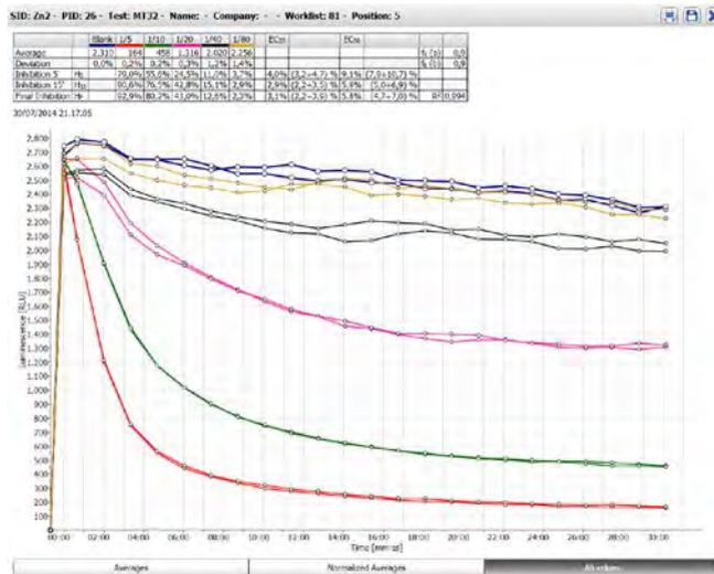
Figura 1 – EasyChem Tox; Rapporto di saggio di un test con ZnSO<sub>4</sub>\*H<sub>2</sub>O (*V. fischeri*, Modern Water)
