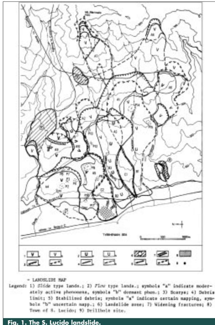
Fig. 1. The S. Lucido landslide.
