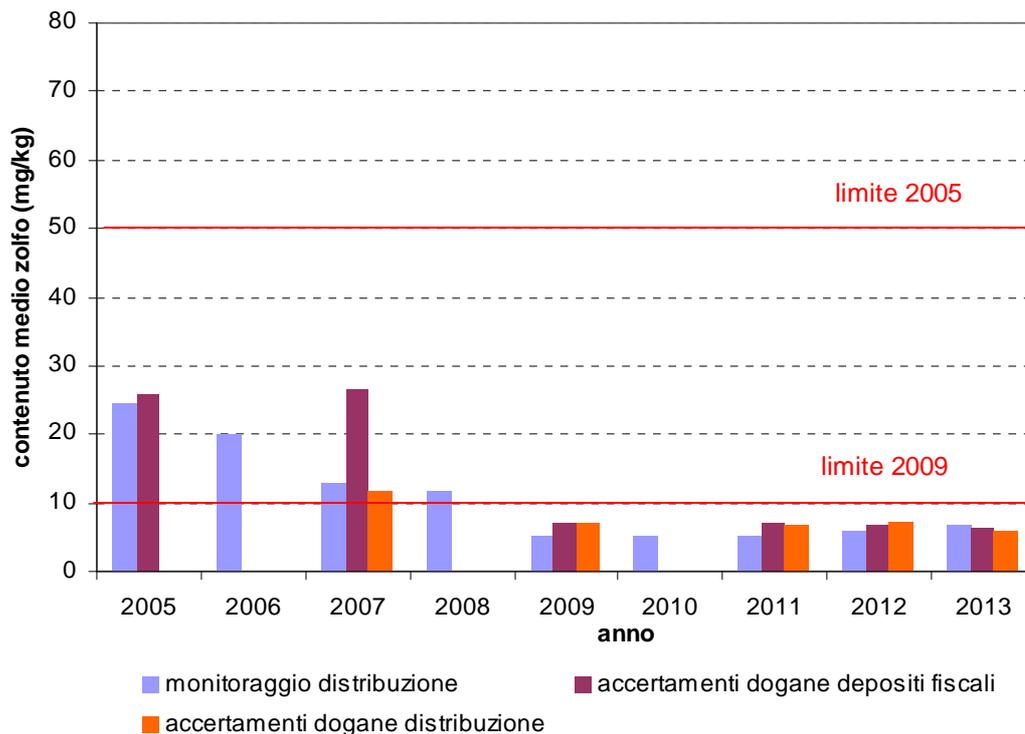
**Figura 7** – Andamento del contenuto medio di zolfo nel combustibile diesel in distribuzione e nel combustibile diesel prodotto/importato.
