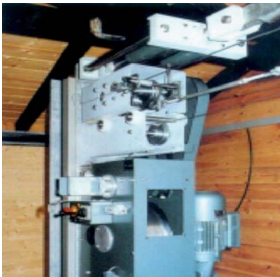
Fig. 49 - Argano di una teleferica
