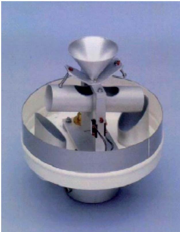
Fig. 12 - Pluviometro a basculanti
