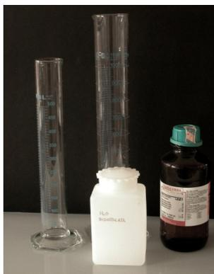
**Figura 3.3** - Vetreria e reagenti per la preparazione della soluzione decalcificante ( $HNO_3$  al 5%). La soluzione deve essere preparata sotto cappa aspirante.
