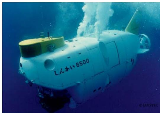
Fig.2. Sommergibile *Shinkai 6500* utilizzato per lo studio del plancton gelatinoso al largo dell'Isola di Hokkaido (Giappone). Courtesy of JAMSTEC, Japan.
