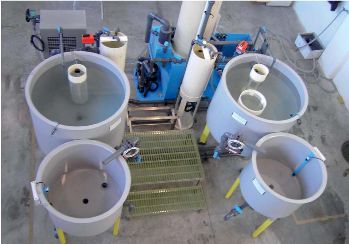
Figura 6. Foto dell'impianto pilota per l'allevamento di copepodi in grandi volumi installato presso la Stazione Zoologica Anton Dohrn di Napoli (Innovacqua S.r.l.).
