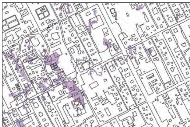
Fig. 9 — Rete di cunicoli e cisterne appartenenti all'acquedotto della Bolla. — Network of tunnel and cisterns belonging to the Bolla Aqueduct.
