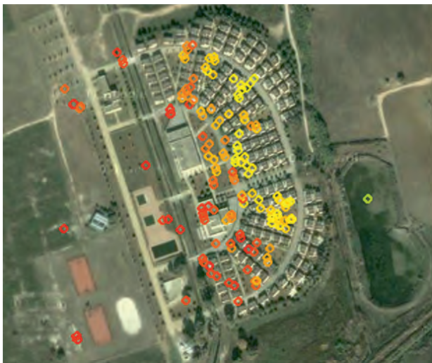
Fig. 8 - Mappa di velocità di deformazione a alta risoluzione relativa ad edifici affetti da subsidenza ubicati a sud della città di Gallipoli (LE), ed esempi di serie storiche di spostamento associate a due punti di misura.
