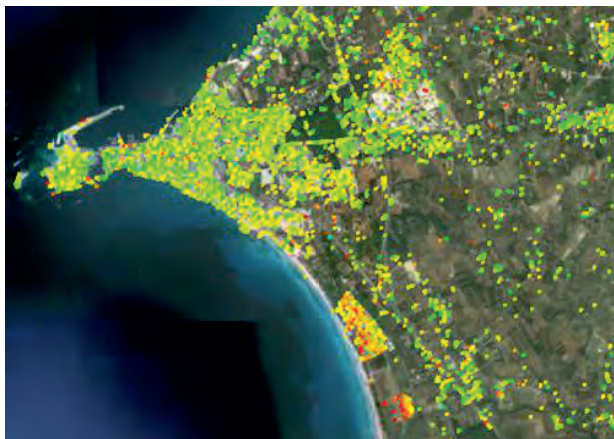
Fig. 6 - Mappa di velocità di deformazione a scala locale relativa alla città di Gallipoli (LE), ottenuta mediante elaborazione di immagini SAR ENVISAT acquisite in orbita ascendente (intervallo temporale: 2003-2010). - Ground deformation velocity map at local scale relevant to the urbanized area of Gallipoli (ENVISAT ascending dataset, time interval 2003-2010).
